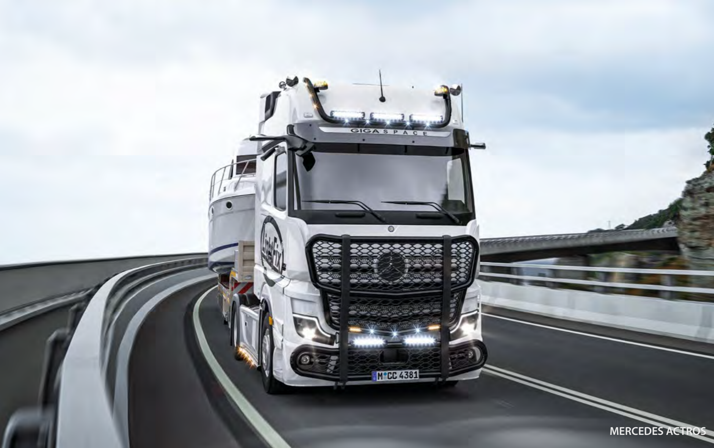
25761-2-B - LightFix - FRONT-PROTECT "BIG NORDIC" Actros Stream Space 2300 mm Griglia frontale con una rete in nero Acciaio inossidabile - verniciato a polvere nero - Ø 70mm - con cablaggio 29708-1-B - LightFix - LAZER-BRIDGE per LAZER Triple-R 1000
