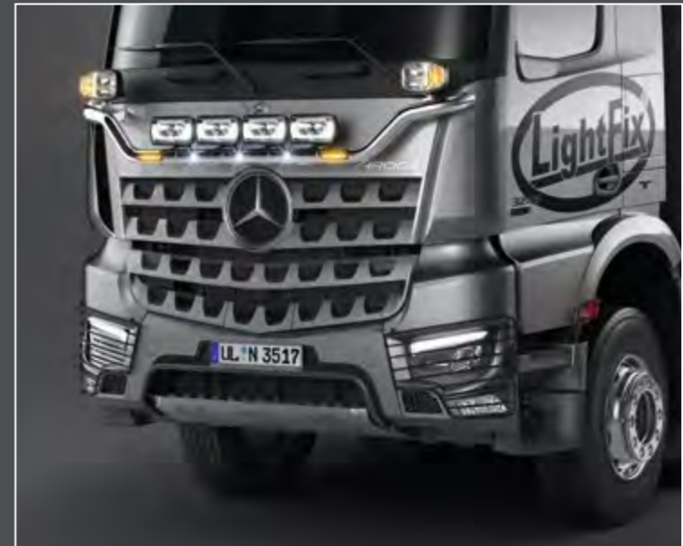
25750-2-P / 25750-3-P - LightFix - PLOW-LIGHT Arocs 2300 (25750-2-P) / Arocs 2500 (25750-3-P) Barra portafari frontale per fino a 4 fari ausiliari e 2 fari principali con indicatori adatto per veicoli spazzaneve e veicoli comunali acciaio inossidabile lucidato a mano - Ø 70mm al 100% predisposto con cablaggio
