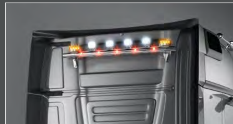
25715-3-P /-B - LightFix - REAR-LIGHT Stream Space 2500 - Big Space - Giga Space Barra portafari per il montaggio fino a 4 fari da lavoro e 2 rotanti Acciaio inossidabile lucidato a mano e verniciato nero - Ø 70mm al 100% predisposto con cablaggio
