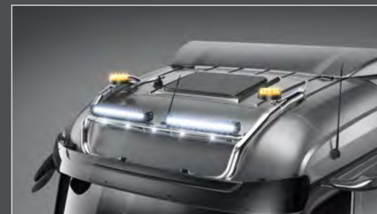
25705-7-P /-B - LightFix - SKY-LIGHT "H-TYPE" Stream Space 2300 / Stream Space 2500 Barra portafari per il montaggio fino a 6 fari ausiliari e 2 rotanti acciaio inossidabile lucidato a mano a verniciato nero Ø 70mm - al 100% predisposto con cablaggio
