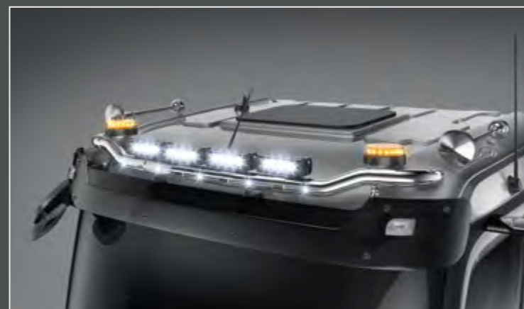
25704-2-P / -B - LightFix - SKY-LIGHT "WING" Classic Space Barra portafari per il montaggio fino a 4 fari ausiliari e 2 rotanti acciaio inossidabile lucidato a mano e verniciato nero Ø 70mm - al 100% predisposto con cablaggio
