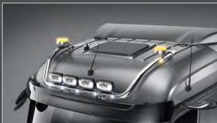
25705-1-P /-B - 25705-6-P /-B - LightFix - SKY-LIGHT Stream Space 2300 (25705-1-P /-B) / Stream Space 2500 (25705-6-P /-B) Barra portafari per il montaggio fino a 4 fari ausiliari e 2 rotanti acciaio inossidabile lucidato a mano a verniciato nero Ø 70mm - al 100% predisposto con cablaggio
