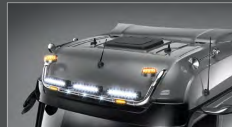
25706-3-P - 25706-4-P - LightFix - SKY-LIGHT "U" Big Space (25706-3-P) / Giga Space (25706-4-P) Barra portafari per il montaggio fino a 6 fari ausiliari e 2 rotanti acciaio inossidabile lucidato a mano - Ø 70mm - al 100% predisposto con cablaggio
