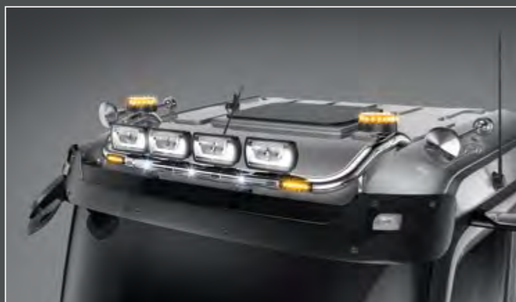
25704-1-P - LightFix - SKY-LIGHT Classic Space Barra portafari per il montaggio fino a 4 / 6 fari ausiliari e 2 rotanti acciaio inossidabile lucidato a mano - Ø 70mm - al 100% predisposto con cablaggio
