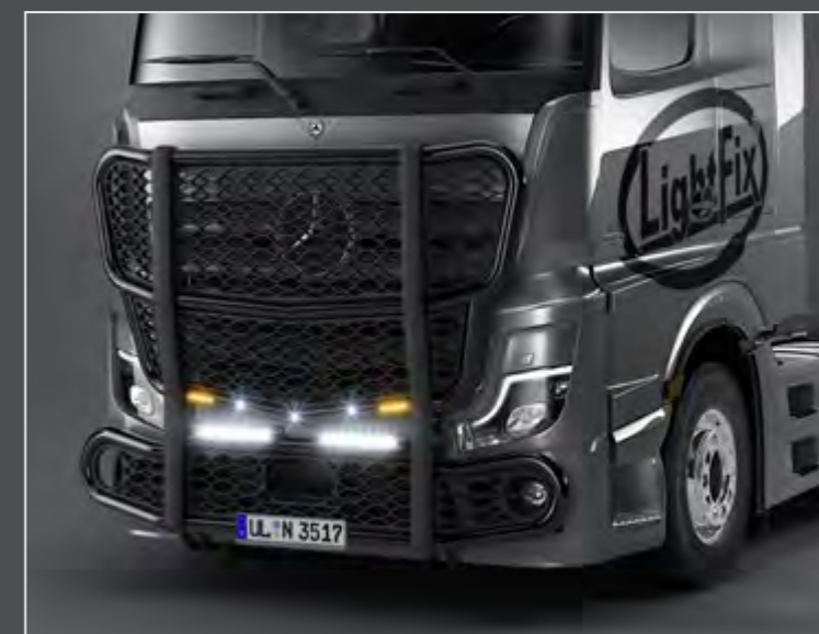
25760-2-B - LightFix - FRONT-PROTECT "BIG NORDIC" Actros 2500 mm Griglia frontale con una rete in nero Acciaio inossidabile - verniciato a polvere nero - Ø 70mm - con cablaggio 29708-1-B - LightFix - LAZER-BRIDGE per LAZER Triple-R 1000
