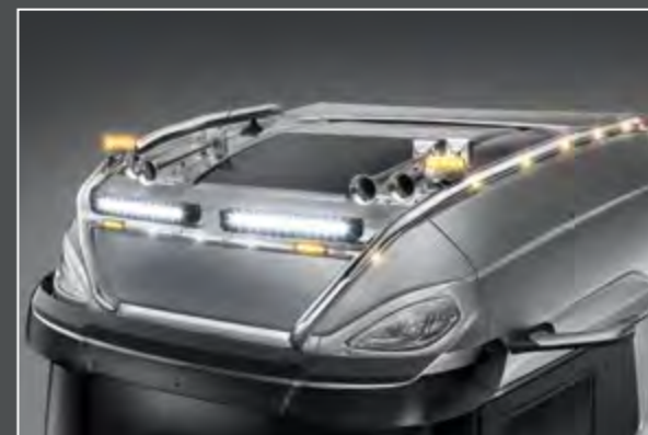
28706-9-P - LightFix - SKY-LIGHT "H-MAX" Lygtebøjle til maksimalt 6 ekstra lygter og advarselslygter. Rustfrit stål - Poleret - Ø 70mm - Færdigtrukket kabel. Rød LED i enden af røret samt 8 gule LED'er på siderne.
