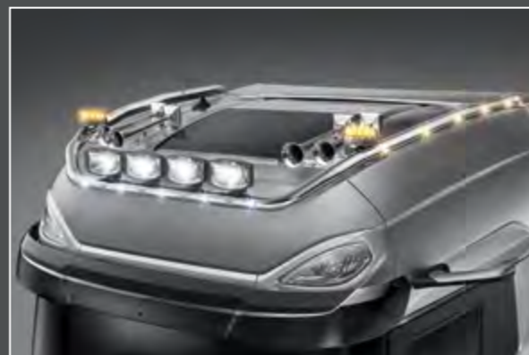
28706-5-P - LightFix - SKY-LIGHT "CLASSIC-MAX" Lygtebøjle til maksimalt 4 ekstra lygter og advarselslygter. Rustfrit stål - Poleret - Ø 70mm - Færdigtrukket kabel. Rød LED i enden af røret samt 8 gule LED'er på siderne.
