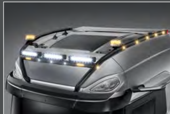
28706-9-B - LightFix - SKY-LIGHT "H-MAX" Lygtebøjle til maksimalt 6 ekstra lygter og advarselslygter. Rustfrit stål - Sort pulverlakeret - Ø 70mm - Færdigtrukket kabel. Rød LED i enden af røret samt 8 gule LED'er på siderne.
