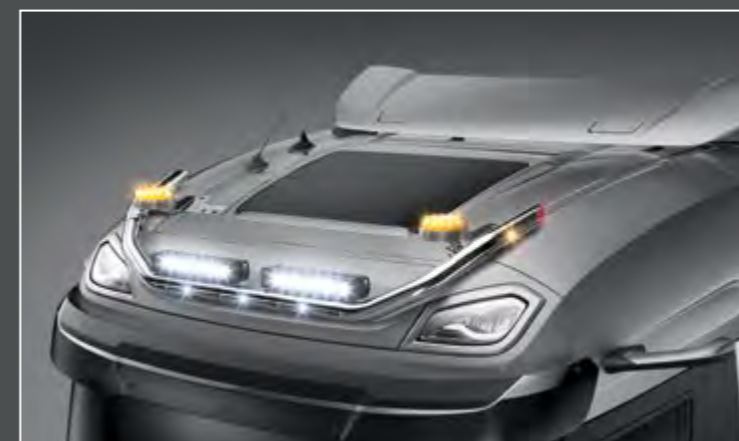
28705-4-P - LightFix - SKY-LIGHT "CLASSIC" Lygtebøjle til maksimalt 4 ekstra lygter og advarselslygter. Rustfrit stål - Poleret - Ø 70mm - Færdigtrukket kabel. Rød LED i enden af røret.
