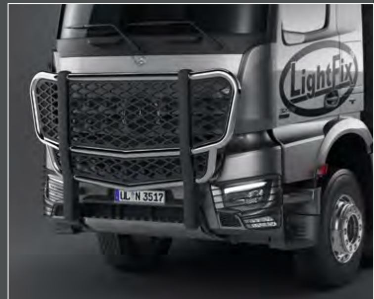
25762-1-P / -B - 25762-2-P / -B - LightFix - FRONT-PROTECT "NORDIC" Arocs Heavy Duty (25762-1-P / -B) / straat versie - 2500mm (25762-2-P / -B) RVS stalen protection bull bar incl. zwart ABS raster gepolijst of zwart gepoedercoat - Ø 70mm - voorzien van bekabeling
