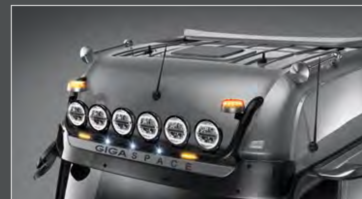
25706-3-B - 25706-4-B - LightFix - SKY-LIGHT "U" Big Space (25706-3-B) / Giga Space (25706-4-B) Daklampenbeugel voor maximaal 6 verstralers en 2 zwaailampen RVS - zwart gepoedercoat - Ø 70mm - voorzien van bekabeling
