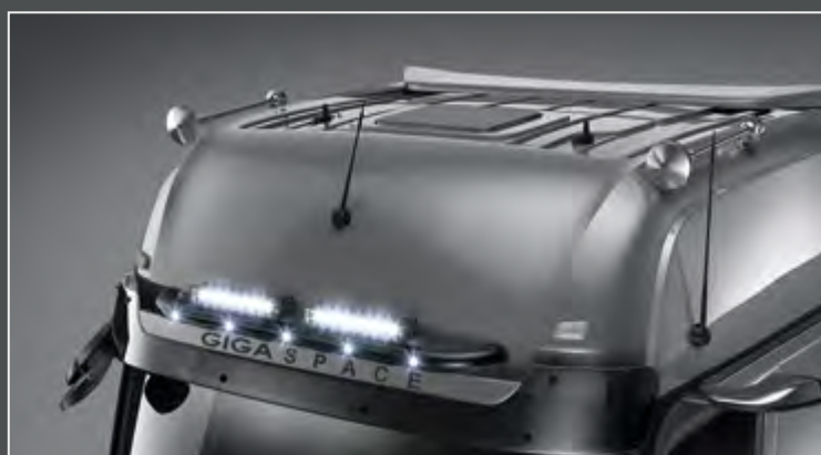
25706-1-B - LightFix - SKY-LIGHT "MINI" Big Space / Giga Space Daklampenbeugel voor maximaal 4 verstralers RVS - zwart gepoedercoat - Ø 70mm - voorzien van bekabeling
