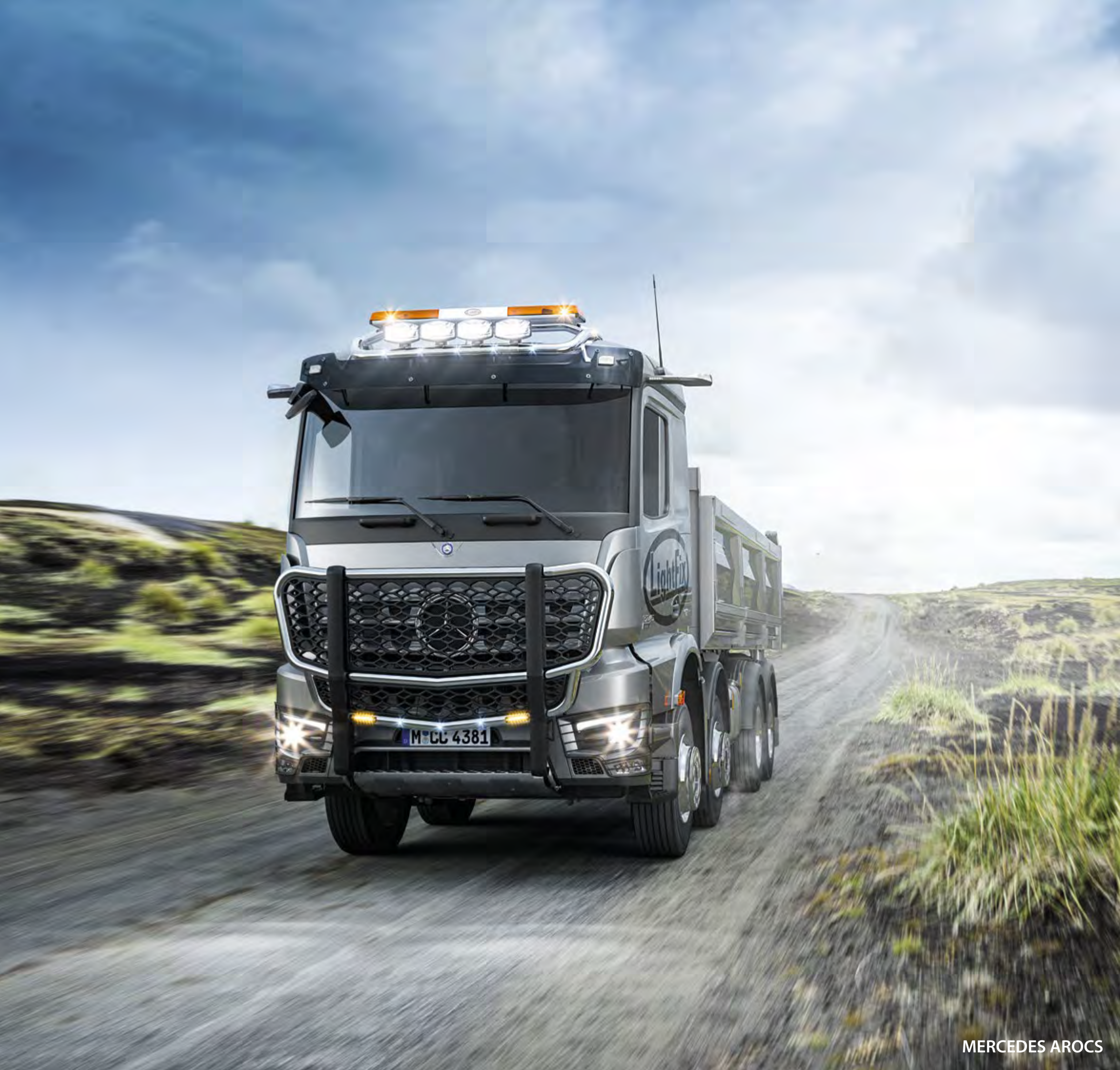
25750-2-P / 25750-3-P - LightFix - PLOW-LIGHT Arocs 2300 (25750-2-P) / Arocs 2500 (25750-3-P) RVS stalen beugel voor de voorkant voor 2 hoofdlampen en maximaal 4 verstralers voor sneeuwpluigen en gemeentelijke voertuigen gepolijst - Ø 70mm - voorzien van bekabeling
