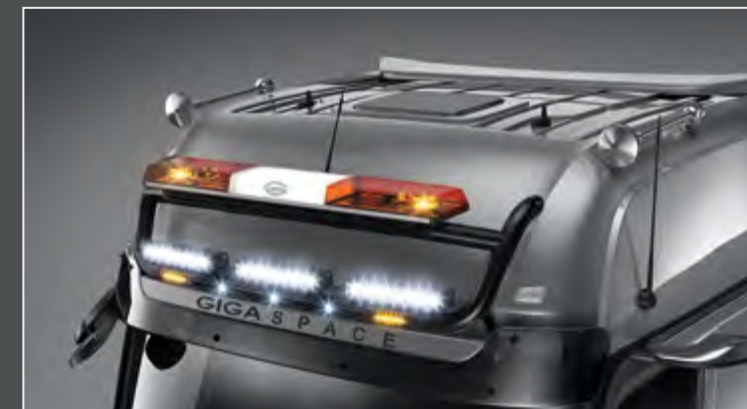
25706-8-B - 25706-9-B - LightFix - SKY-LIGHT + SKY-BRIDGE Big Space (25706-8-B) / Giga Space (25706-9-B) Daklampenbeugel met dwarsbalk voor maximaal 6 verstralers en flitslampbalk RVS - zwart gepoedercoat - Ø 70mm - voorzien van bekabeling
