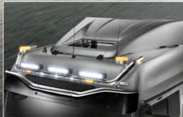
21702-9-P /-B - LightFix - SKY-LIGHT "WILDLIFE" Daklampenbeugel voor maximaal 6 verstralers en 2 zwaailampen RVS - gepolijst of zwart gepoedercoat - Ø 70mm voorzien van bekabeling incl. rode LED's in het uiteinde
