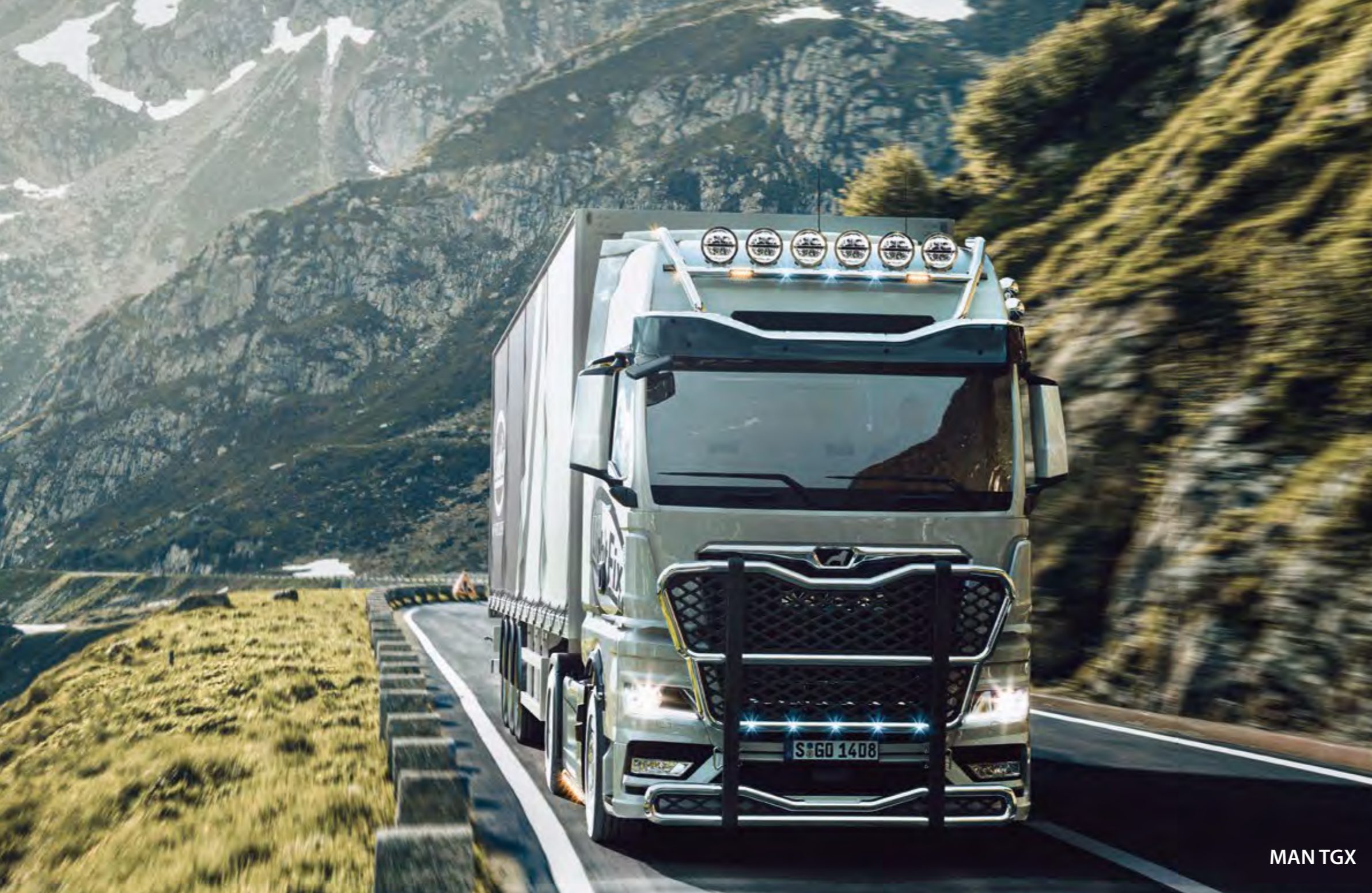
21760-4-P /-B - LightFix - FRONT-PROTECT "BIG NORDIC" RVS stalen protection bull bar incl. zwart ABS raster gepolijst of zwart gepoedercoat - Ø 70mm - voorzien van bekabeling 29708-1-P /-B - LightFix - LAZER-BRIDGE voor 2 Lazer Triple-R 1000
