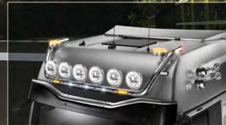
21706-4-P /-B - LightFix - SKY-LIGHT "WILDLIFE" Daklampenbeugel voor maximaal 6 verstralers en 2 zwaailampen RVS - gepolijst of zwart gepoedercoat - Ø 70mm - voorzien van bekabeling incl. rode LED's in het uiteinde
