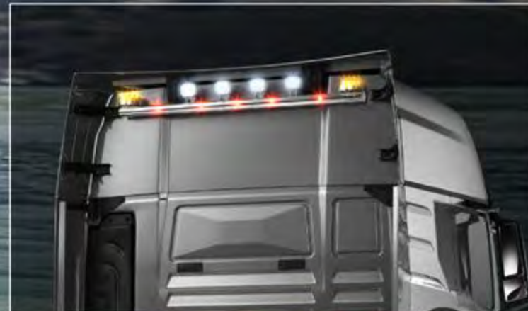
21715-2-P /-B - LightFix - REAR-LIGHT MAN TGX GX - MAN TGX GM Lygtebøjle til maksimalt 4 arbejdslygter og 2 advarselslygter. Rustfrit stål - Poleret eller sort pulverlakeret - Ø 70 mm - Færdigtrukket kabel. Til montering på tagspoileren.
