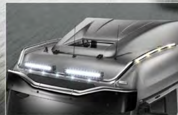
21702-10-P /-B - LightFix - SKY-LIGHT "WILDLIFE MAX" Lygtebøjle til maksimalt 6 ekstra lygter og advarslygter. Rustfrit stål - Poleret eller sort pulverlakeret. Ø 70 mm - Færdigtrukket kabel. Rød LED i enden af røret samt 8 gule LED'er på siderne.
