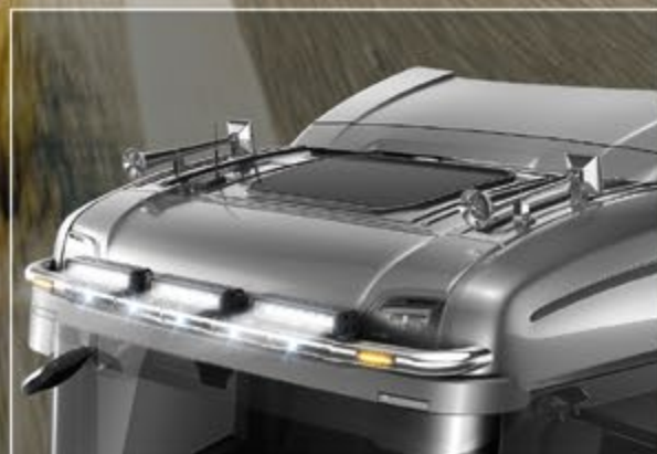
24705-2-P /-B - LightFix - SKY-LIGHT Ekstralysbøyle for montering av maksimalt 4 / 6 ekstralys Rustfritt stål - polert eller sort pulverlakkert - Ø 70mm montert kabel
