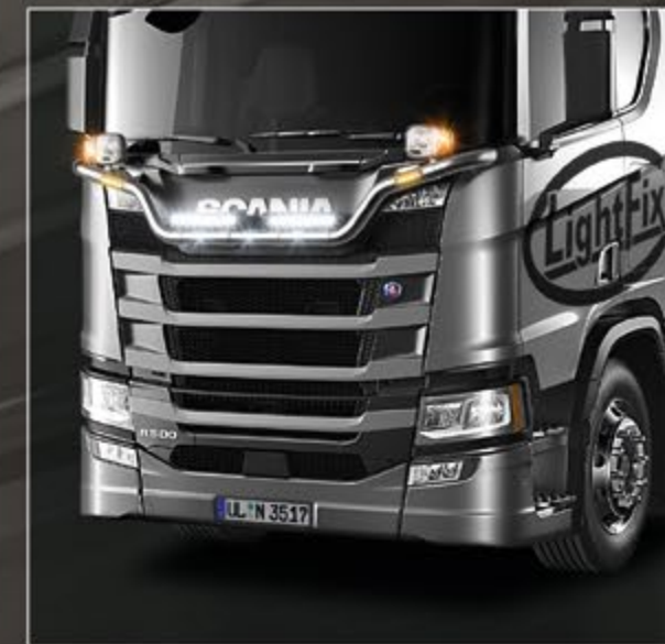
24751-1-P /-B - LightFix - PLOW-LIGHT Brøytelysbøyle i fronten av kjøretøyet for montering av maksimalt 2 hovedlyskaster med blinklys og 4 ekstralys Rustfritt stål - polert eller sort pulverlakkert Ø 70mm - montert kabel
