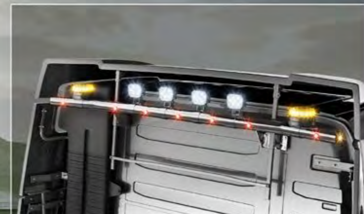
TLG23715-3-P / -B - LightFix - REAR-LIGHT Globetrotter / Globetrotter XL/XXL Dachlampenbügel für maximal 4 Arbeitsscheinwerfer und 2 Kennleuchten Edelstahl - hochglanzpoliert oder schwarz pulverbeschichtet - Ø 70mm - Kabelsatz
