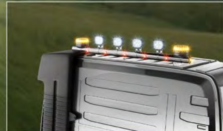
TLG23715-2-P / -B - LightFix - REAR-LIGHT Globetrotter ohne Dachspoiler / flaches Fahrerhaus Dachlampenbügel für maximal 4 Arbeitsscheinwerfer und 2 Kennleuchten Edelstahl - hochglanzpoliert oder schwarz pulverbeschichtet - Ø 70mm - Kabelsatz
