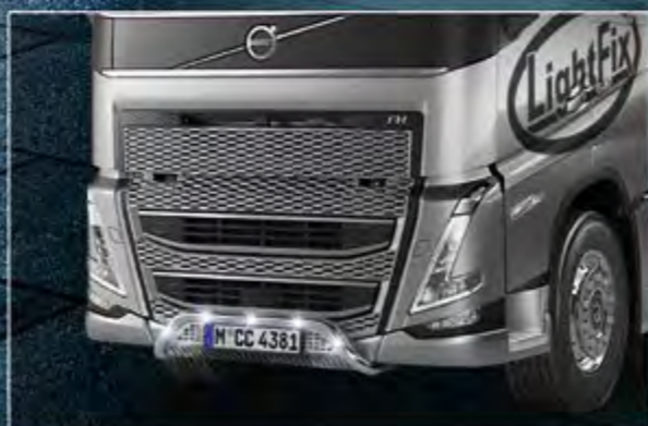
TLG23740-2-P /-B - LightFix - FRONT-LINER "TARGA" - FH Lampenbügel für die Front aus Edelstahl mit Unterfahrerschutz hochglanzpoliert oder schwarz pulverbeschichtet Ø 60mm - Kabelsatz inkl. 5 weißen LEDs nach vorne
