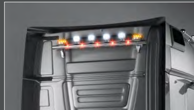
25715-3-P /-B - LightFix - REAR-LIGHT Stream Space 2500 - Big Space - Giga Space Dachlampenbügel für maximal 4 Arbeitsscheinwerfer und 2 Kennleuchten Edelstahl - hochglanzpoliert oder schwarz pulverbeschichtet - Ø 70mm - Kabelsatz
