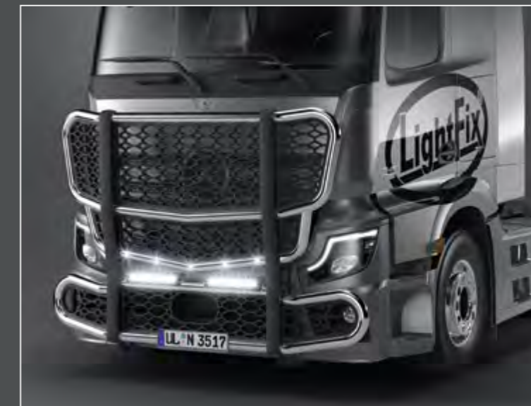
25761-2-P - LightFix - FRONT-PROTECT "BIG NORDIC" Actros Stream Space, Fahrzeugbreite 2300 mm Frontschutzgrill aus Edelstahl inkl. schwarzem Schutznetz aus ABS hochglanzpoliert - Ø 70mm - Kabelsatz 29708-1-P - LightFix - LAZER-BRIDGE für 2 Lazer Triple-R 1000
