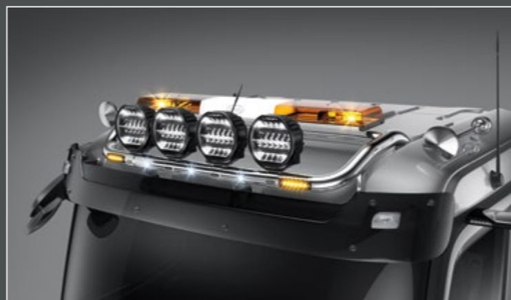
25704-8-P /-B - LightFix - SKY-LIGHT + SKY-BRIDGE Classic Space Dachlampenbügel mit Querrohr für maximal 4 Scheinwerfer und einen Warnbalken Edelstahl - hochglanzpoliert oder schwarz pulverbeschichtet - Ø 70mm - Kabelsatz
