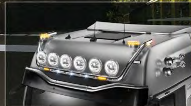
21706-4-P /-B - LightFix - SKY-LIGHT "WILDLIFE" Dachlampenbügel für max. 6 Scheinwerfer und 2 Kennleuchten Edelstahl - hochglanzpoliert oder schwarz pulverbeschichtet - Ø 70mm - mit Kabelsatz inkl. roten LEDs in den Rohrenden
