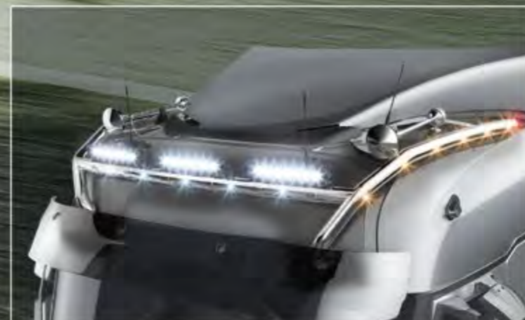
TLG20701-5-P /-B - LightFix - SKY-LIGHT "WILDLIFE MAX" Barra portafari per il montaggio fino a 6 fari ausiliari e 2 rotanti Acciaio inossidabile lucidato a mano o verniciato nero - Ø 70mm al 100% predisposto con cablaggio nei lati si trovano LED in arancioni e in rosso
