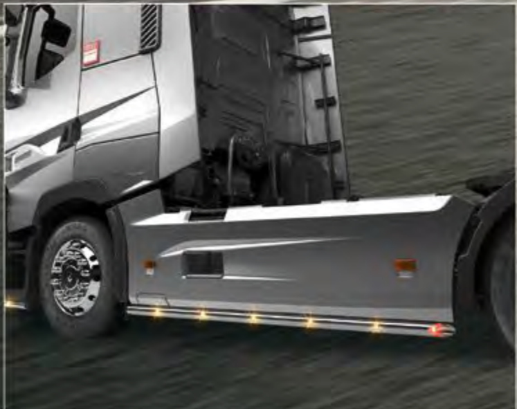
TLG20740-6-P /-B - LightFix - SIDE-LINER Coppia di tubi laterali in acciaio lucidato a mano o verniciato nero al 100% predisposto con cablaggio e spina di connessione completo di LED rossi alle estremità del tubo e LED arancioni ai lati
