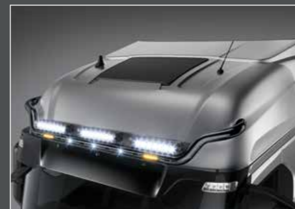
27705-4-B - LightFix - SKY-LIGHT "WING" Daklampenbeugel voor maximaal 6 verstralers en 2 zwaailampen RVS - zwart gepoedercoat - Ø 70mm - voorzien van bekabeling
