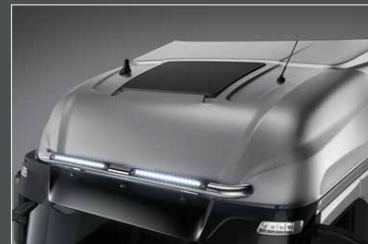
27705-2-P - LightFix - SKY-LIGHT "SLIM" Daklampenbeugel voor montage van 2 geïntegreerde LED verstralers RVS - gepolijst - Ø 70mm - voorzien van bekabeling
