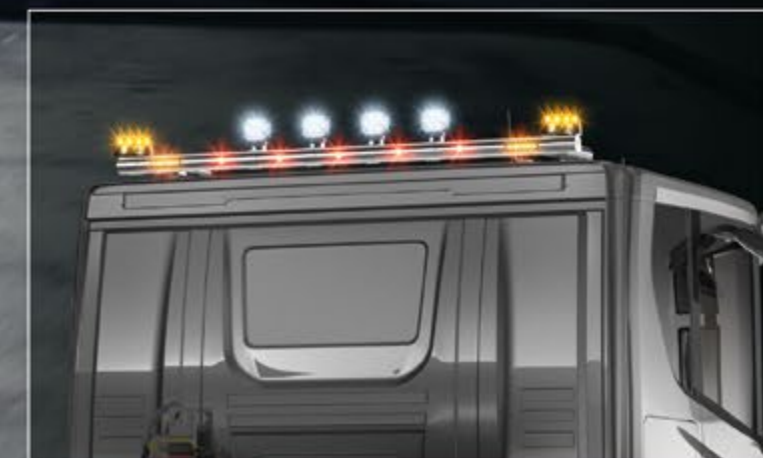
24716-1-P / B - LightFix - REAR-LIGHT Dachlampenbügel für maximal 6 Arbeitsscheinwerfer und 2 Kennleuchten Edelstahl - hochglanzpoliert oder schwarz pulverbeschichtet Ø 70mm - mit Kabelsatz
