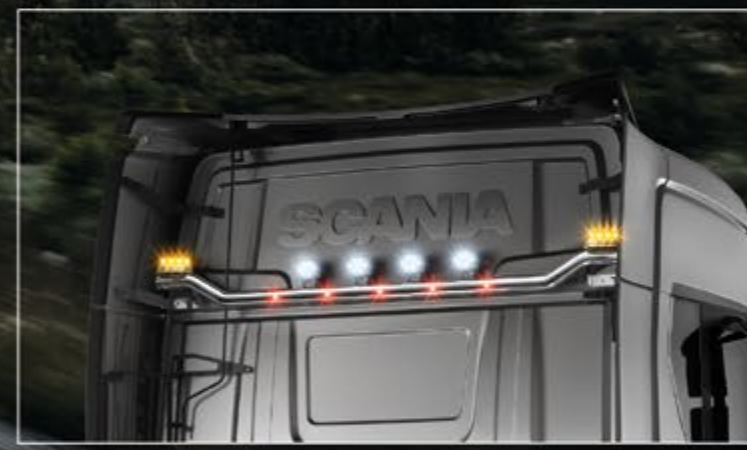
24716-2-P /-B - LightFix - REAR-LIGHT Extraljusbåge för montage av maximalt 4 arbetsljus och 2 varningsljus polerad eller svart pulverlackerad - Ø 70mm - monterad kabel
