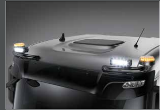
27706-5-B - LightFix - SKY-EYES Dachlampenbügel für 2 Scheinwerfer und 2 Kennleuchten Edelstahl - schwarz pulverbeschichtet Ø 70mm - mit Kabelsatz
