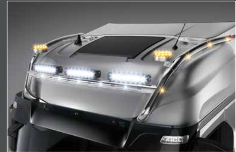
27705-5-P - LightFix - SKY-LIGHT "MAX" Dachlampenbügel für die Montage von max. 6 Scheinwerfern und 2 Kennleuchten Edelstahl - hochglanzpoliert - Ø 70mm - mit Kabelsatz inkl. roten LEDs in den Rohrenden und orangen LEDs an den Seiten
