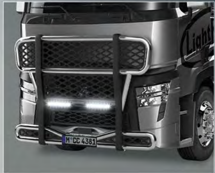
TLG20760-2-P /-B - LightFix - FRONT-PROTECT "BIG NORDIC" Przednie orurowanie ochronne ze stali nierdzewnej wraz z czarną siatką z tworzywa ABS - polerowana / czarny lub czarny - Ø 70mm - z okablowaniem TLG29708-1-P /-B -LightFix - LAZER-BRIDGE z Lazer Triple-R 1000
