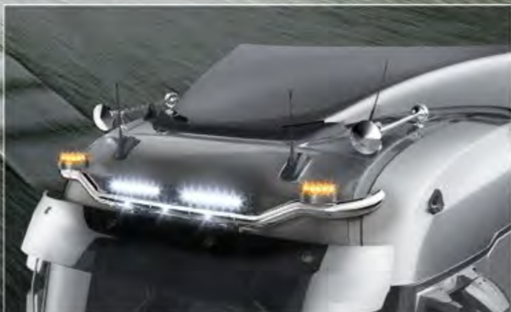
TLG20701-2-P / B - LightFix - SKY-LIGHT "WING" Rama dachowa do maksymalnie 4 reflektory i lampy sygnalizacyjne Stal nierdzewna - polerowana lub czarny - Ø 70mm - z okablowaniem
