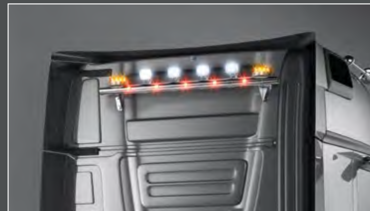
25715-3-P /-B - LightFix - REAR-LIGHT Stream Space 2500 - Big Space - Giga Space Lysbøjle til montering af maksimalt 4 arbejdslygter og advarselslygter. Rustfrit stål - Poleret eller sort pulverlakeret - Ø 70mm - Færdigtrukket kabel.
