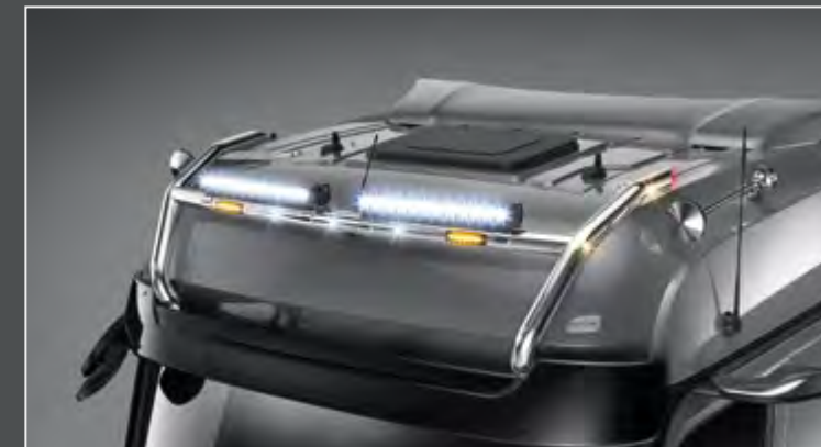
25707-1-P - 25707-2-P - LightFix - SKY-LIGHT "H-TYPE" Big Space (25707-1-P) / Giga Space (25707-2-P) Lygtebøjle til montering af maksimalt 6 ekstra lygter og advarselslygter. Rustfrit stål - Poleret - Ø 70 mm - Færdigtrukket kabel. Rød LED i enden af røret.
