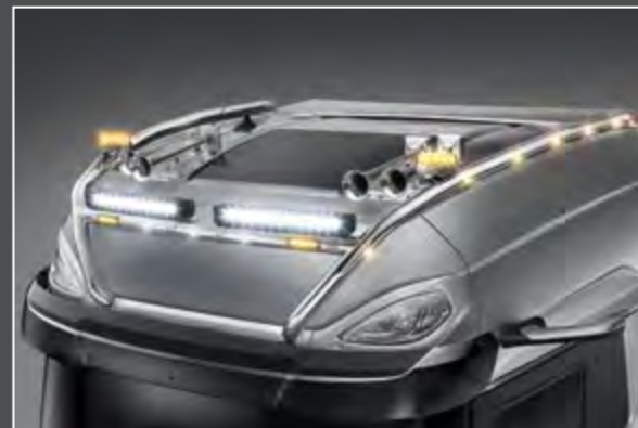
28706-9-P - LightFix - SKY-LIGHT "H-MAX" Rama dachowa do maksymalnie 6 reflektorów i lampy sygnalizacyjne Stal nierdzewna - polerowana - Ø 70mm - z okablowaniem 2 czerwone i 8 pomarańczowe LED zintegrowane
