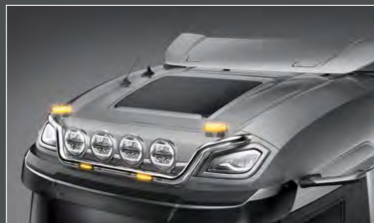
28705-3-P - LightFix - SKY-LIGHT "CLASSIC" Rama dachowa na maksymalnie 4 reflektory i lampy sygnalizacyjne Stal nierdzewna - polerowana - Ø 70mm - z okablowaniem czerwone LED na końcówkach rury
