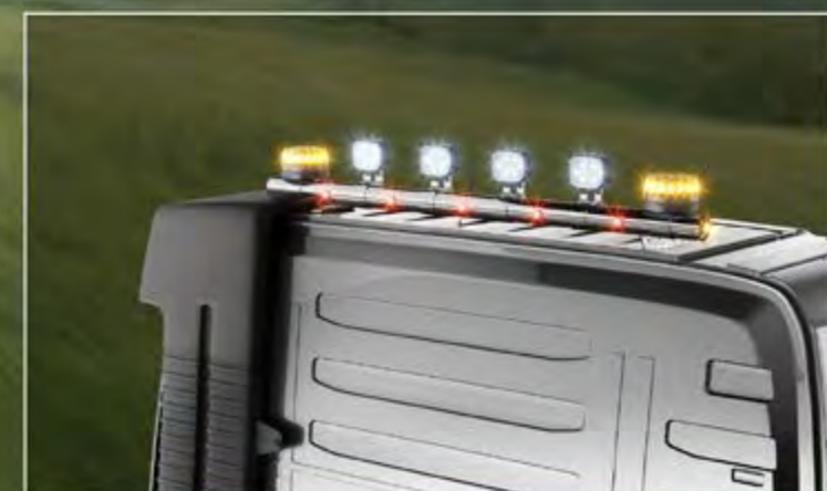
TLG23715-2-P / -B - LightFix - REAR-LIGHT Kabina sypialna / Globetrotter bez spojlerze dachowym Rama dachowa do maksymalnie 4 reflektory robocze i lampy sygnalizacyjne Stal nierdzewna - polerowana lub czarny - Ø 70mm - z okablowaniem
