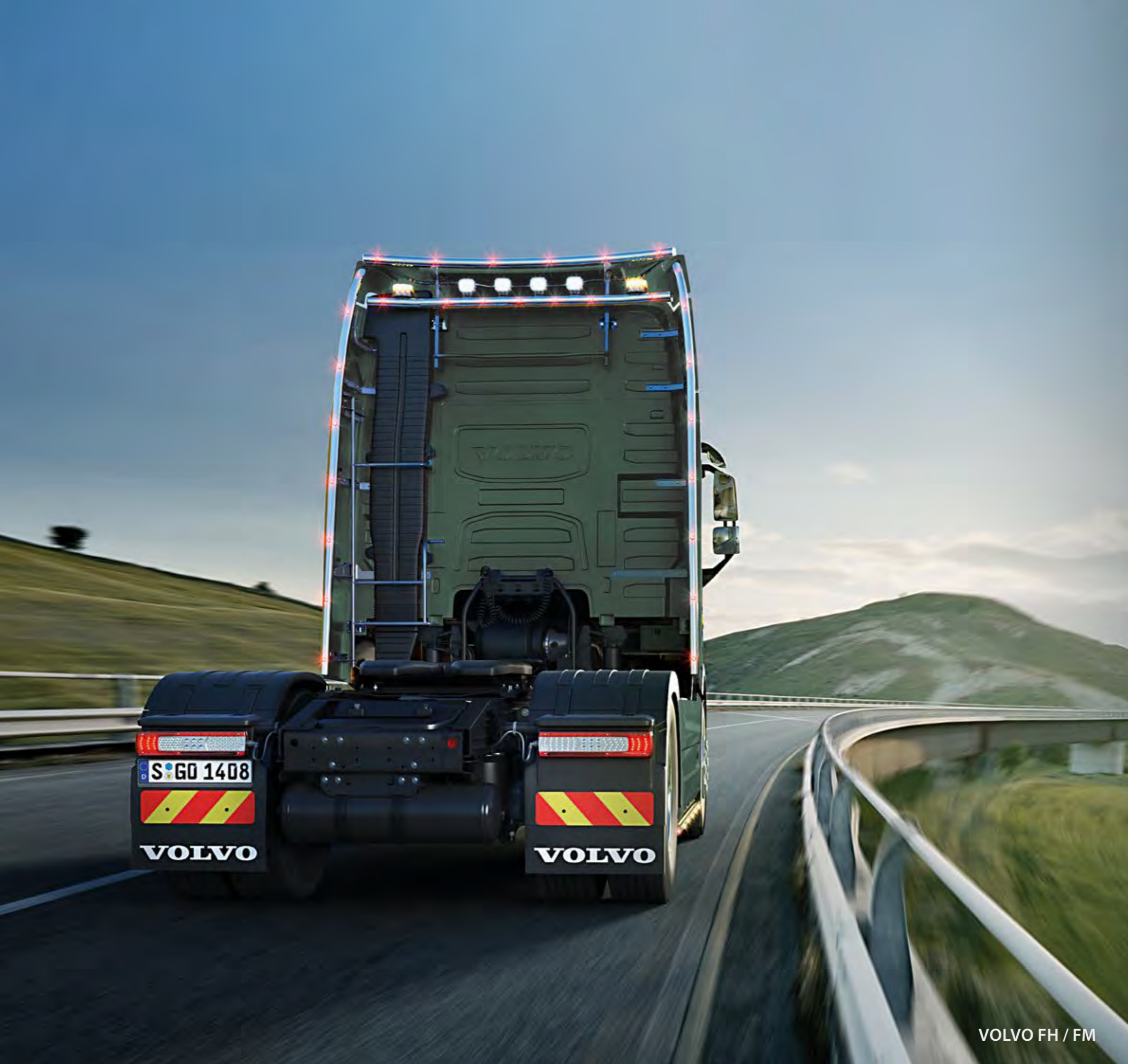
TLG23748-8-P / -B - LightFix - ROOF-LINER rama lamp ze stali nierdzewnej na 4 reflektory roboczych i 2 lamp ostrzegawczych polerowana lub czarny - Ø 70mm - z okablowaniem 6 czerwone diody LED zintegrowe we orurowaniu
