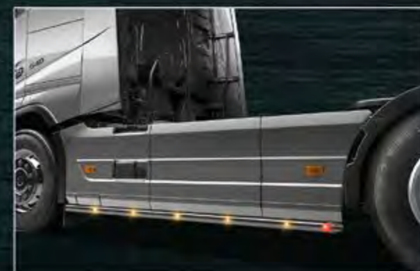
TLG23741-5-P /-B - TLG23741-6-P /-B - LightFix - SIDE-LINER 3700mm (TLG23741-5-P /-B) / 3800mm (TLG23741-6-P /-B) Boczne orurowanie ochronne ze stali nierdzewnej w zestawie polerowana lub czarny - Ø 60mm - z okablowaniem 5 pomarańczowe diody LED zintegrowane po bokach i czerwone LED na końcówkach rury
