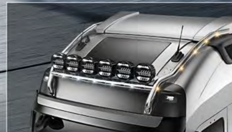
TLG23705-6-P / -B - TLG23705-7-P / -B - LightFix - SKY-LIGHT "WILDLIFE MAX" Globetrotter (TLG23705-6-P / -B) / Globetrotter XL/XXL (TLG23705-7-P / -B) Rama dachowa do maksymalnie 6 reflektorów i lampy sygnalizacyjne Stal nierdzewna - polerowana lub czarny - Ø 70mm - z okablowaniem 2 czerwone i 6 pomarańczowe LED zintegrowane
