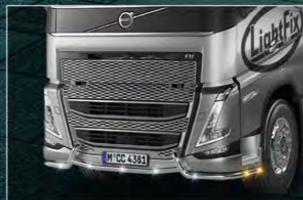
TLG23741-3-P /-B - LightFix - FRONT-LINER "S" Orurowanie lamp LED ze stali nierdzewnej polerowana lub czarny - Ø 60mm - z okablowaniem w zestawie 5 białe diody LED z przodu i 4 pomarańczowe LED po bokach
