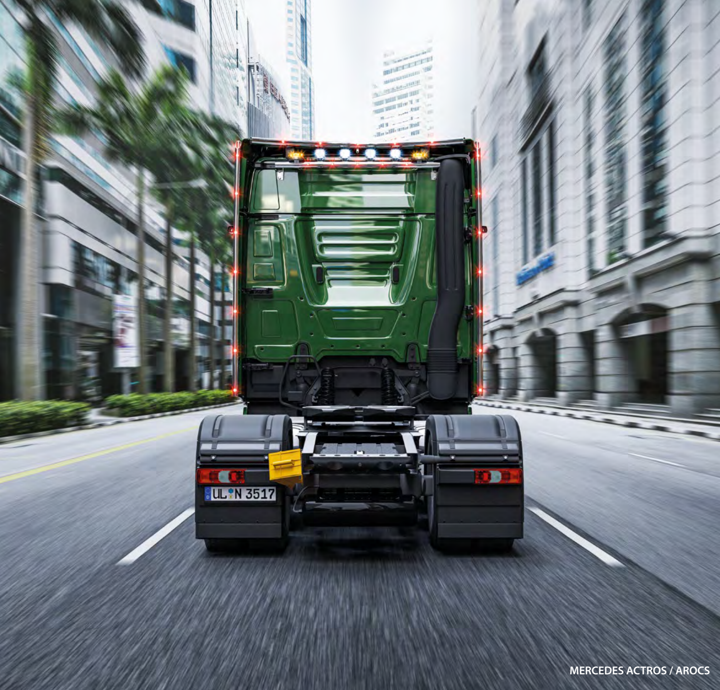
25749-1-P /-B - LightFix - ROOF-LINER - Actros Giga Space 25749-2-P /-B - LightFix - ROOF-LINER - Actros Big Space + Giga Space "Lowliner" rama lamp ze stali nierdzewnej na 4 reflektory roboczych i 2 lamp ostrzegawczych polerowana lub czarny - Ø 70mm - z okablowaniem czerwone diody LED zintegrowane we orurowaniu
