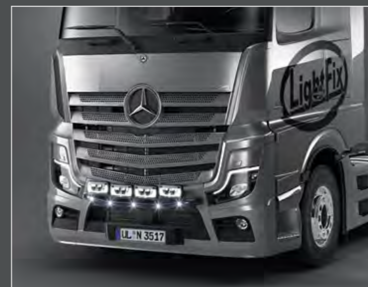
25720-3-B - LightFix - 4-LIGHT "MINI" Przednie orurowanie lamp na maksymalnie 4 reflektory Stal nierdzewna - czarny - Ø 70mm - z okablowaniem
