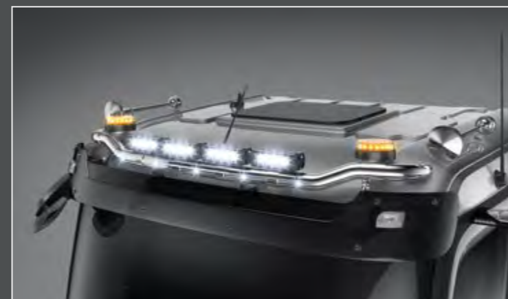
25704-2-P / -B - LightFix - SKY-LIGHT "WING" Classic Space Rama dachowa na maksymalnie 4 reflektory i belka sygnalizacyjna Stal nierdzewna - polerowana lub czarna - Ø 70mm - z okablowaniem
