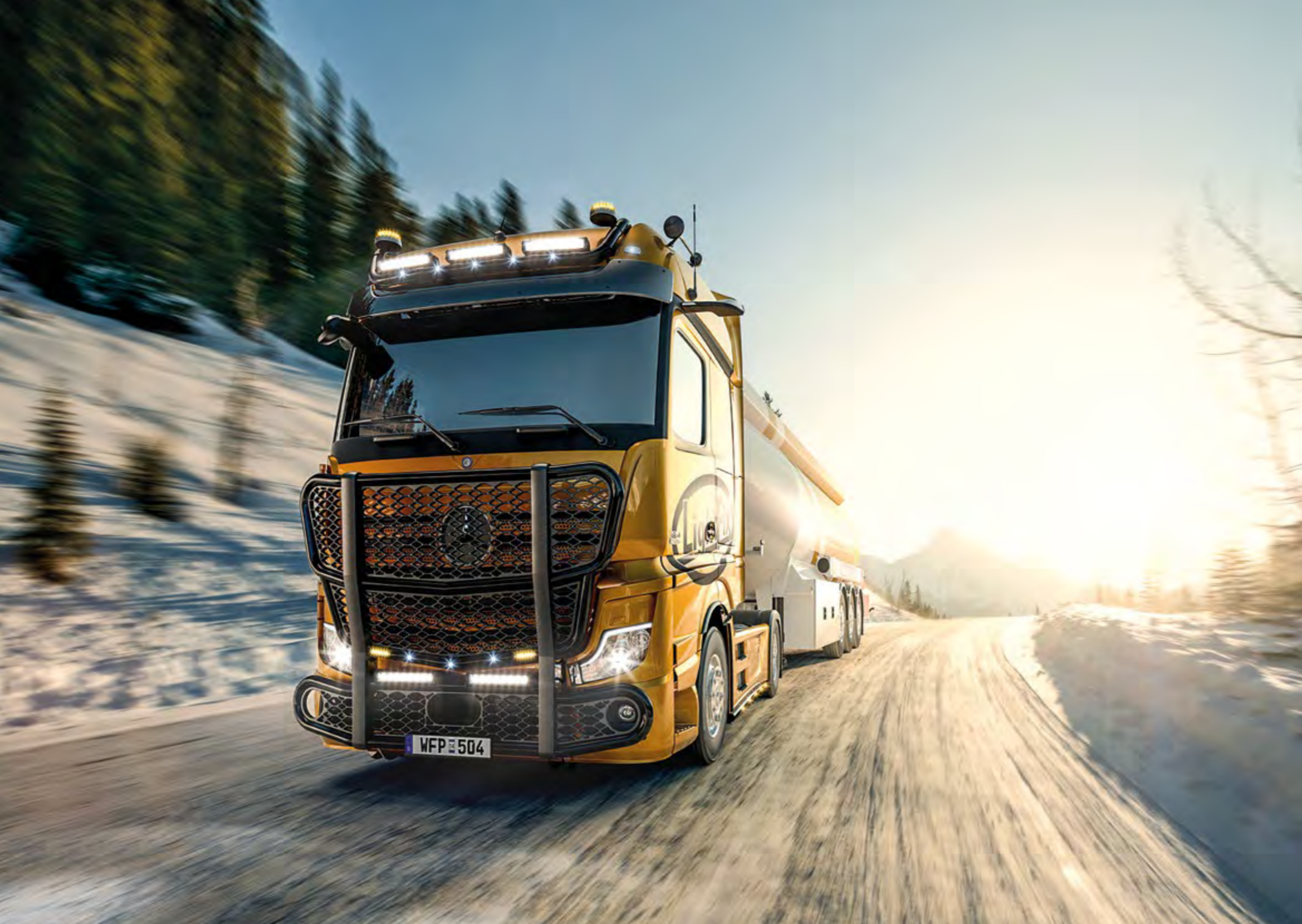
25707-3-B - 25707-4-B - LightFix - SKY-LIGHT Big Space (25707-3-B) / Giga Space (25707-4-B) Rama dachowa do maksymalnie 6 reflektorów i lampy sygnalizacyjne Stal nierdzewna - czarny - Ø 70mm - z okablowaniem czerwone LED na końcówkach rury
