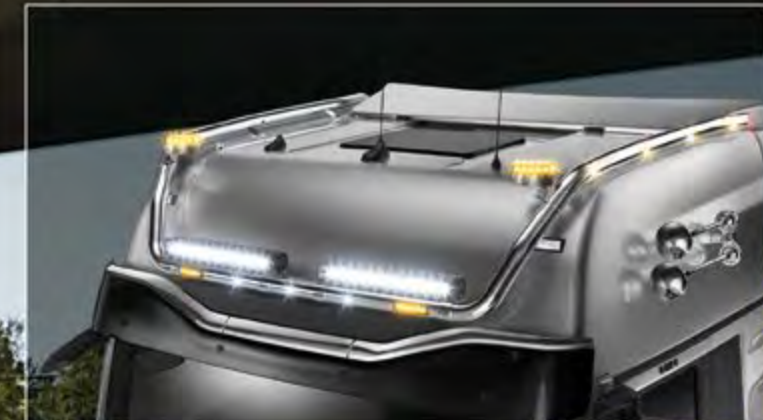
21706-5-P /-B - LightFix - SKY-LIGHT "WILDLIFE MAX" Ekstralysbøyle for maksimalt 6 ekstralys og 2 rotorblinklys Rustfritt stål - polert eller sort pulverlakkert - Ø 70mm - monteret kabel inkl. rød LED på enden av røret og 8 orange LED på siden
