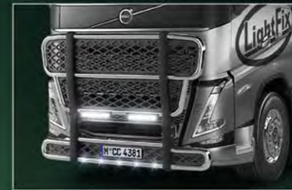
TLG23760-2-P /-B - LightFix - FRONT-PROTECT "BIG NORDIC" - FH TLG23761-2-P /-B - LightFix - FRONT-PROTECT "BIG NORDIC" - FM Frontskydd i rostfritt stål inkl. svart galler i ABS polerad eller svart pulverlackerad - Ø 70mm - monterad kabel TLG29708-1-P /-B - LightFix - LAZER-BRIDGE för Lazer Triple-R 1000
