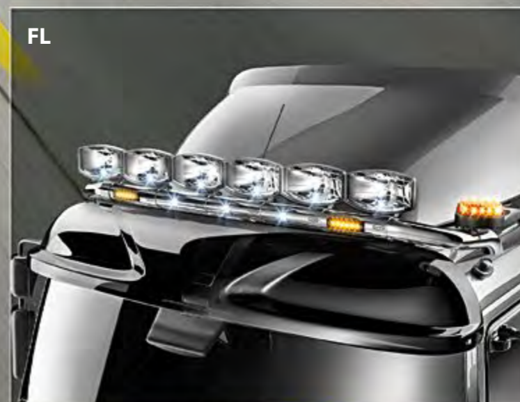
FL TLG23706-2-P - LightFix - SKY-LIGHT Extraljusbåge för maximalt 6 extraljus och 2 varningsljus Rostfritt stål - polerad - Ø 70mm - monterad kabel
