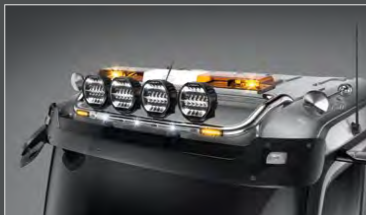
25704-8-P - LightFix - SKY-LIGHT + SKY-BRIDGE Classic Space Ekstralysbøyle med ekstra mellomrør for maksimalt 4 / 6 ekstralys og rotorbjelke Rustfritt stål - polert - Ø 70mm - montert kabel
