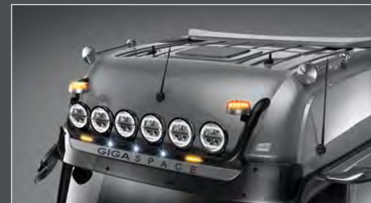
25706-3-B - 25706-4-B - LightFix - SKY-LIGHT "U" Big Space (25706-3-B) / Giga Space (25706-4-B) Ekstralysbøyle for montering av maksimalt 6 ekstralys og rotorblinklys Rustfritt stål - sort pulverlakkert - Ø 70mm - montert kabel
