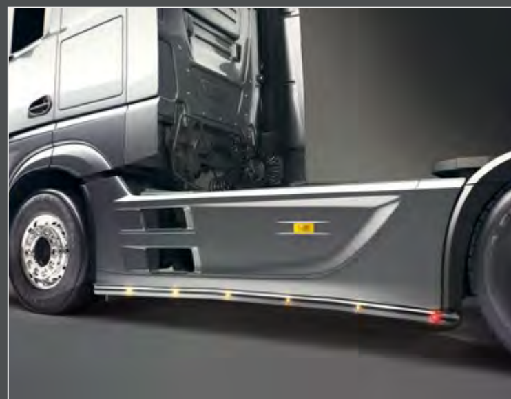
25740-5-P - 25740-6-P - 25740-7-P - LightFix - SIDE-LINER WB 3700 (25740-5-P) / WB 3850 (25740-6-P) / WB 3550 (25740-7-P) LED-Lysbøyle (set) i rustfritt stål polert - Ø 60mm - montert kabel og kontakter inkl. rød LED på enden av røret og orange LED på siden
