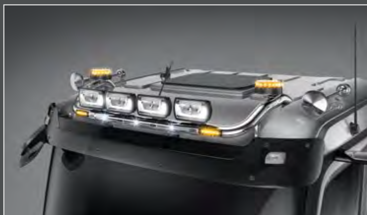
25704-1-P - LightFix - SKY-LIGHT Classic Space Ekstralysbøyle for maksimalt 4 / 6 ekstralys og rotorblinklys Rustfritt stål - polert - Ø 70mm - montert kabel
