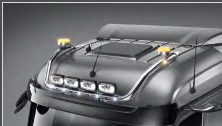
25705-1-P /-B - 25705-6-P /-B - LightFix - SKY-LIGHT Stream Space 2300 (25705-1-P /-B) / Stream Space 2500 (25705-6-P /-B) Ekstralysbøyle for montering av maksimalt 4 ekstralys og rotorblinklys Rustfritt stål - polert eller sort pulverlakkert - Ø 70mm - montert kabel
