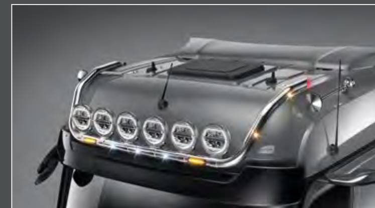
25707-3-P - 25707-4-P - LightFix - SKY-LIGHT Big Space (25707-3-P) / Giga Space (25707-4-P) Ekstralysbøyle for montering av maksimalt 6 ekstralys og rotorblinklys Rustfritt stål - polert - Ø 70mm - montert kabel inkl. rød LED på enden av røret
