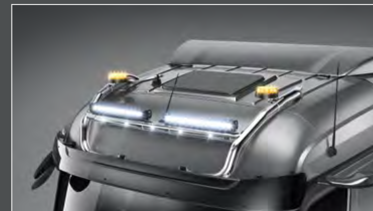
25705-7-P /-B - LightFix - SKY-LIGHT "H-TYPE" Stream Space 2300 / Stream Space 2500 Ekstralysbøyle for montering av maksimalt 6 ekstralys og rotorblinklys Rustfritt stål - polert eller sort pulverlakkert - Ø 70mm - montert kabel
