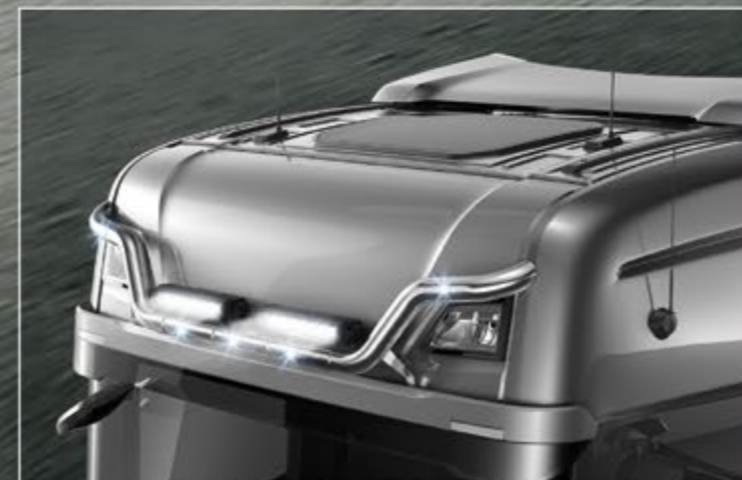
24705-3-P / B - LightFix - SKY-LIGHT "WING" Rama dachowa do maksymalnie 4 reflektory Stal nierdzewna - polerowana lub czarna - Ø 70mm - z okablowaniem
