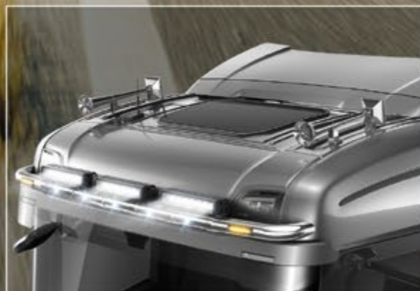
24705-2-P - LightFix - SKY-LIGHT Rama dachowa do maksymalnie 4 / 6 reflektorów Stal nierdzewna - polerowana lub czarny - Ø 70mm z okablowaniem
