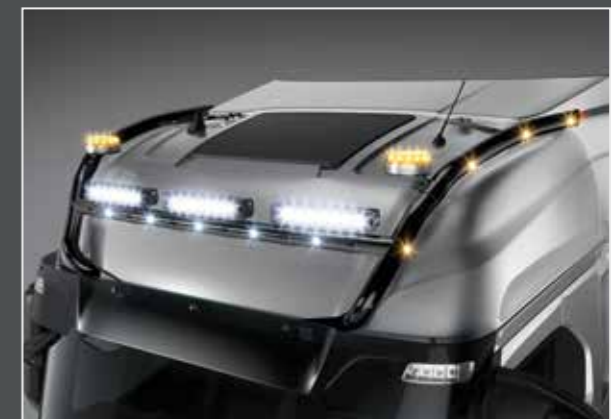
27705-5-B - LightFix - SKY-LIGHT "MAX" Lygtebøjle til maksimalt 6 ekstra lygter og advarselslygter. Rustfrit stål - Sort pulverlakeret - Ø 70mm - Færdigtrukket kabel. Rød LED i enden af røret samt gule LED'er på siderne.
