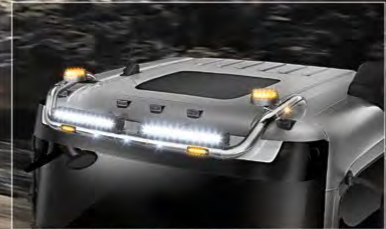
TLG23704-9-P /-B - LightFix - SKY-LIGHT Slaapcabine Daklampenbeugel voor max. 6 verstralers en 2 zwaailampen RVS - gepolijst of zwart gepoedercoat - Ø 70mm - voorzien van bekabeling
