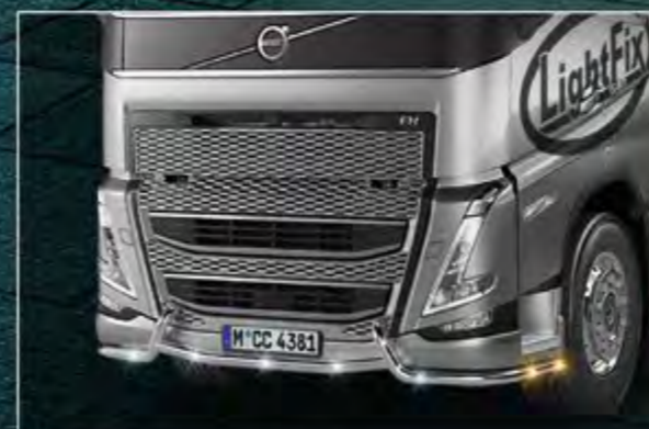
TLG23741-3-P /-B - LightFix - FRONT-LINER "S" RVS stalen beugel voor de voorkant gepolijst of zwart gepoedercoat - Ø 60mm - voorzien van bekabeling incl. 5 witte LED's aan de voorzijde en 4 oranje LED's aan de zijkanten
