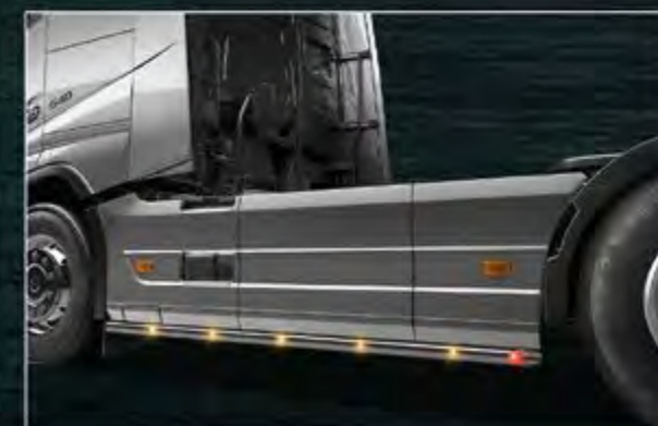
TLG23741-5-P /-B - TLG23741-6-P /-B - LightFix - SIDE-LINER 3700mm (TLG23741-5-P /-B) / 3800mm (TLG23741-6-P /-B) RVS stalen beugel voor de zijkant gepolijst of zwart gepoedercoat - Ø 60mm - voorzien van bekabeling incl. rode LED's in het uiteinde en 10 oranje LED's aan de zijkanten
