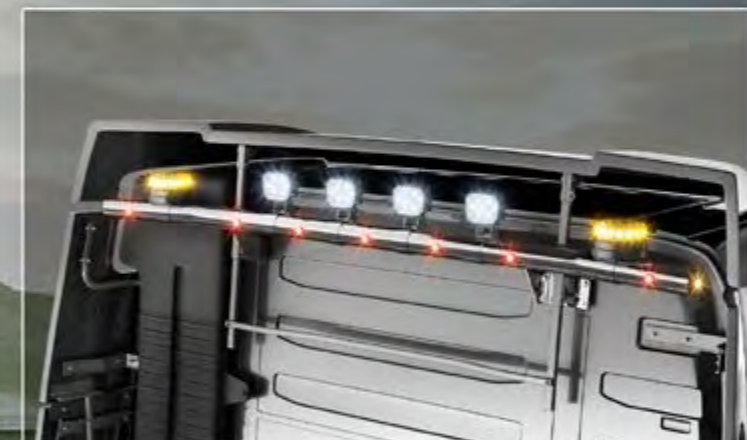
TLG23715-3-P /-B - LightFix - REAR-LIGHT Globetrotter / Globetrotter XL/XXL RVS stalen lampbeugel voor montage van max. 4 werklampen en zwaailampen gepolijst of zwart gepoedercoat - Ø 70mm - voorzien van bekabeling
