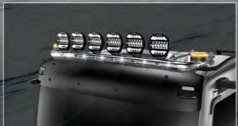
21704-2-P /-B - LightFix - SKY-LIGHT Barra portafari per il montaggio fino a 6 fari ausiliari e 2 rotanti acciaio inossidabile lucidato a mano o verniciato nero Ø 70mm - al 100% predisposto - con cablaggio
