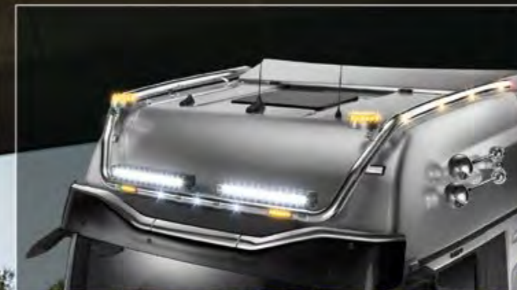
21706-5-P /-B - LightFix - SKY-LIGHT "WILDLIFE MAX" Barra portafari per il montaggio fino a 6 fari ausiliari e 2 rotanti acciaio inossidabile lucidato a mano o verniciato nero Ø 70mm - al 100% predisposto con cablaggio nelle prolunghe sono già incluso 8 LED arancioni e 2 in rosso
