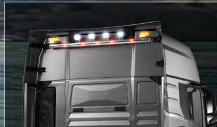
21715-2-P /-B - LightFix - REAR-LIGHT MAN TGX GX - MAN TGX GM Per il montaggio sullo spoiler della cabina Barra portafari per il montaggio fino a 4 fari da lavoro e 2 rotanti acciaio inossidabile lucidato a mano o verniciato nero - Ø 70mm al 100% predisposto con cablaggio
