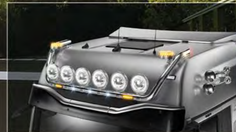
21706-4-P /-B - LightFix - SKY-LIGHT "WILDLIFE" Barra portafari per il montaggio fino a 6 fari ausiliari e 2 rotanti acciaio inossidabile lucidato a mano o verniciato nero Ø 70mm - al 100% predisposto - con cablaggio incl. alla fine del tubo si trovano LED in rosso
