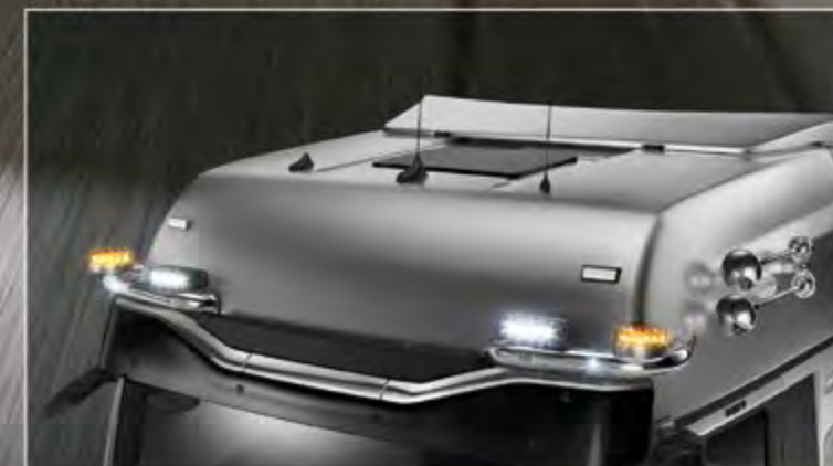
21706-10-P - LightFix - SKY-EYES Barra portafari per il montaggio fino a 2 fari ausiliari e 2 rotanti acciaio inossidabile lucidato a mano Ø 70mm - al 100% predisposto - con cablaggio
