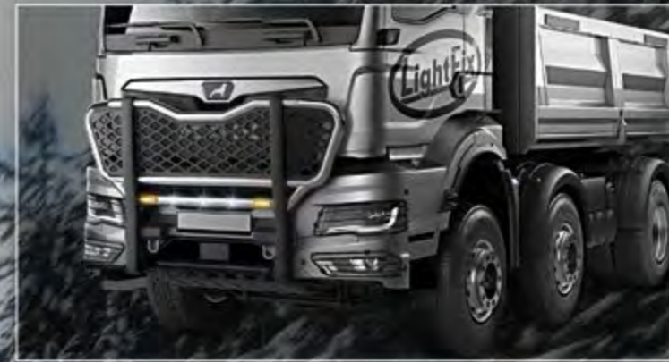
21762-3-P /-B - LightFix - FRONT-PROTECT "NORDIC" Griglia frontale con una rete in nero acciaio inossidabile lucidato a mano o verniciato nero Ø 70mm - al 100% predisposto - con cablaggio 29708-1-P /-B - LightFix - LAZER-BRIDGE per LAZER Triple-R 1000
