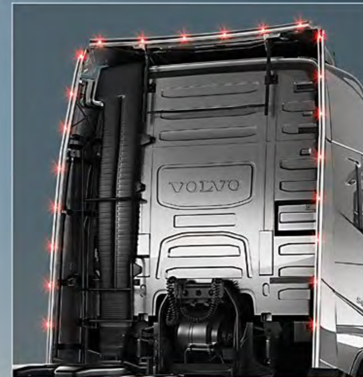
TLG23748-8-P /-B - LightFix - ROOF-LINER Barra portafari per fino a 4 fari da lavoro e 2 rotanti per lo spoiler della cabina Acciaio inossidabile lucidato a mano o verniciato nero - Ø 70mm al 100% predisposto con cablaggio - completo di LED rossi
