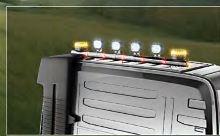
TLG23715-2-P /-B - LightFix - REAR-LIGHT Globetrotter senza spoiler tetto / cabina con tetto basso Barra portafari per il montaggio fino a 4 fari da lavoro e 2 rotanti Acciaio inossidabile lucidato a mano o verniciato nero - Ø 70mm al 100% predisposto con cablaggio
