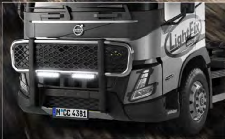
TLG23761-1-P - LightFix - FRONT-PROTECT "NORDIC" Griglia frontale con una rete in nero Acciaio inossidabile lucidato a mano - Ø 70mm al 100% predisposto con cablaggio TLG29708-1-B - LightFix - LAZER-BRIDGE per LAZER Triple-R 1000
