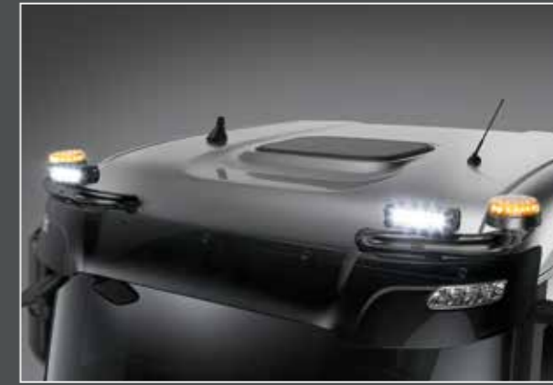
27706-5-B - LightFix - SKY-EYES Ekstralysbøyle for montering av 2 ekstralys og rotorblinklys Rustfritt stål - polert eller sort pulverlakkert Ø 70mm - montert kabel
