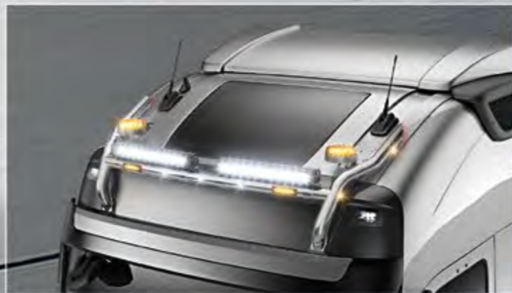
TLG23704-7-P /-B - TLG23704-8-P /-B - LightFix - SKY-LIGHT "WILDLIFE" Globetrotter (TLG23704-7-P /-B) / Globetrotter XL/XXL (TLG23704-8-P /-B) Rampe de toit pour la fixation de 6 phares et de 2 gyrophares Inox - poli à haute brillance ou noir thermolaqué - Ø 70mm - précâblage incl. LED rouges à l'arrière
