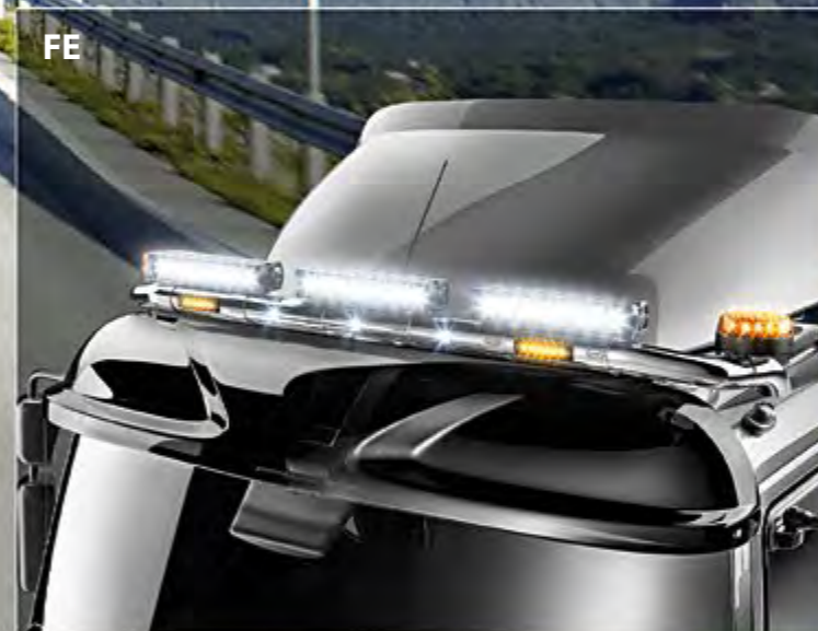
TLG23706-1-P - LightFix - SKY-LIGHT Rampe de toit pour la fixation de 6 phares et de 2 gyrophares Inox - poli à haute brillance - Ø 70mm - précâblage
