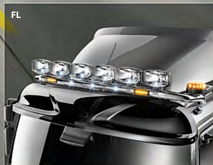
TLG23706-2-P - LightFix - SKY-LIGHT Rampe de toit pour la fixation de 6 phares et de 2 gyrophares Inox - poli à haute brillance - Ø 70mm - précâblage
