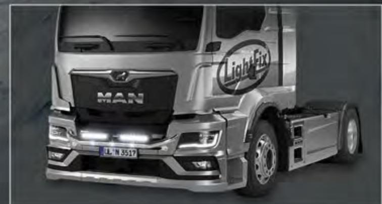
21720-6-P /-B - LightFix - 4-LIGHT "MINI" Extraljubåge för montage av maximalt 4 extraljus Rostfritt stål - polerad eller svart pulverlackerad - Ø 70mm - monterad kabel
