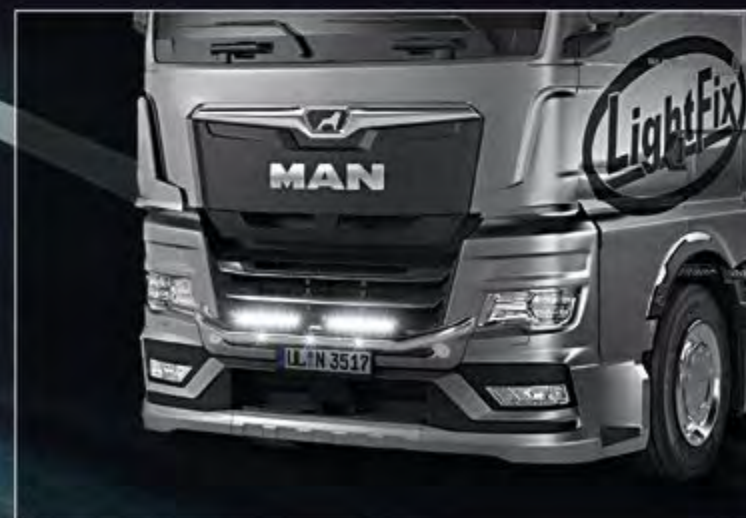
21720-6-P /-B - LightFix - 4-LIGHT "MINI" Extraljubåge för montage av maximalt 4 extraljus Rostfritt stål - polerad eller svart pulverlackerad - Ø 70mm - monterad kabel
