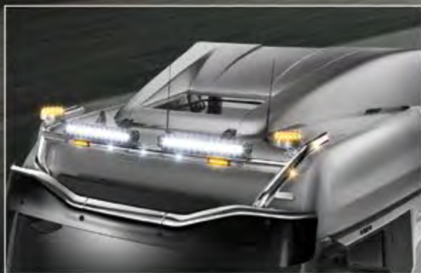
21702-5-P/-B - LightFix - SKY-LIGHT "H-TYPE" Extraljusbåge för montage av maximalt 6 extraljus och varningsljus Rostfritt stål - polerad eller svart pulverlackerad Ø 70mm - monterad kabel inkl. röda LED i slutet av röret
