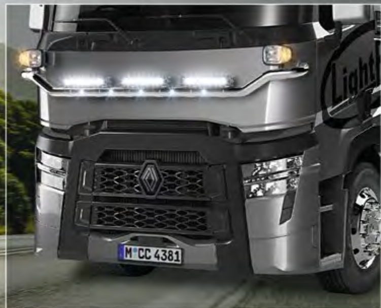
TLG20750-1-P - LightFix - PLOW-LIGHT Extraljusbåge för 6 extraljus och 2 plogstrålkastare med blinkers Rostfritt stål - polerad - Ø 70mm - monterad kabel
