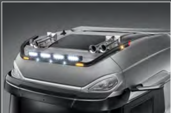
28706-4-B - LightFix - SKY-LIGHT "CLASSIC" Daklampenbeugel voor maximaal 4 verstralers en 2 zwaailampen RVS - zwart gepoedercoat - Ø 70mm - voorzien van bekabeling incl. rode LEDs in het uiteinde
