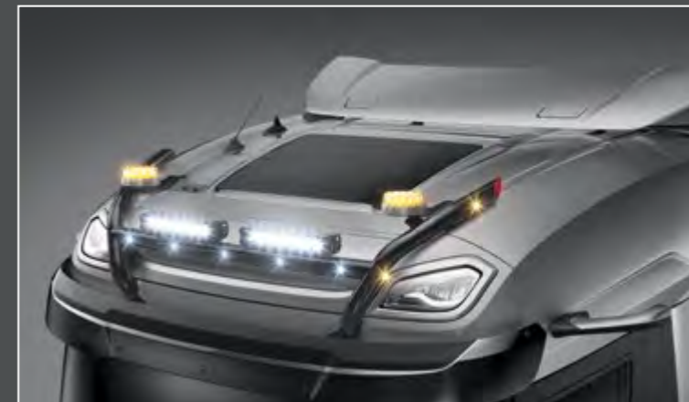
28705-8-B - LightFix - SKY-LIGHT "H-TYPE" Daklampenbeugel voor maximaal 4 verstralers en 2 zwaailampen RVS - zwart gepoedercoat - Ø 70mm - voorzien van bekabeling incl. rode LEDs in het uiteinde
