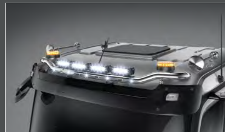
25704-2-P / -B - LightFix - SKY-LIGHT "WING" Classic Space Extraljusbåge för montage av maximalt 4 extraljus och 2 varningsljus Rostfritt stål - polerad eller svart pulverlackerad - Ø 70mm - monterad kabel
