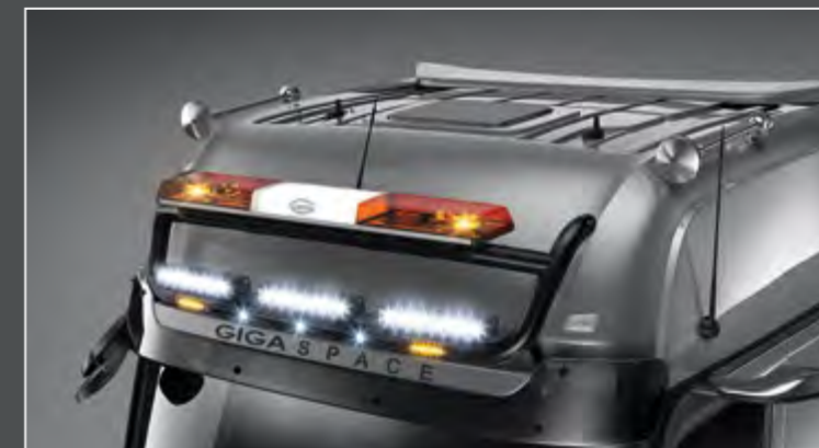
25706-8-B - 25706-9-B - LightFix - SKY-LIGHT + SKY-BRIDGE Big Space (25706-8-B) / Giga Space (25706-9-B) Extraljusbåge med mellanrör för montage av maximalt 6 extraljus och en takljusramp Rostfritt stål - svart pulverlackerad - Ø 70mm - monterad kabel
