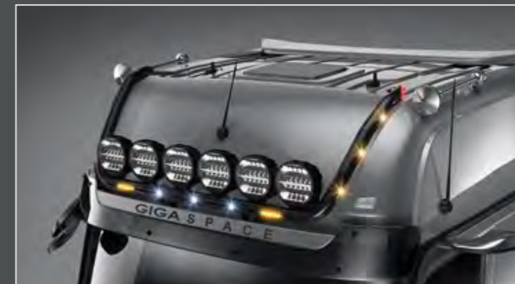
25707-3-B - 25707-4-B - LightFix - SKY-LIGHT Big Space (25707-3-B) / Giga Space (25707-4-B) Extraljusbåge för montage av maximalt 6 extraljus och 2 varningsljus Rostfritt stål - svart pulverlackerad - Ø 70mm - monterad kabel inkl. röda LED i slutet av röret
