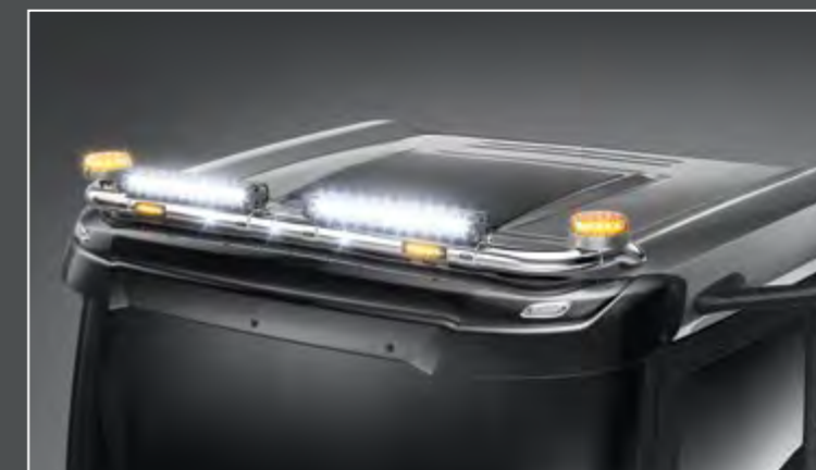
28704-3-P /-B - LightFix - SKY-LIGHT Extraljusbåge för montage av maximalt 6 extraljus och 2 varningsljus Rostfritt stål - polerad eller svart pulverlackerad - Ø 70mm - monterad kabel
