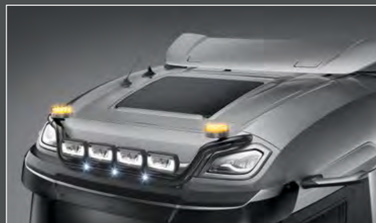
28705-3-B - LightFix - SKY-LIGHT "WING" Extraljusbåge för montage av maximalt 4 extraljus och 2 varningsljus Rostfritt stål - svart pulverlackerad - Ø 70mm - monterad kabel
