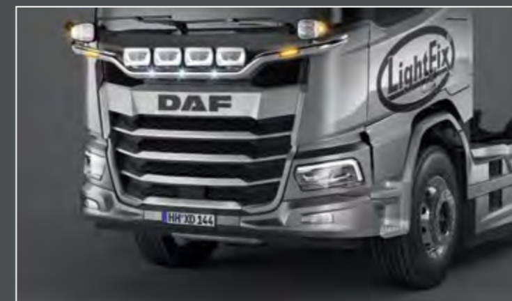
28750-2-P - LightFix - PLOW-LIGHT Plogljusbåge för montage av maximalt 4 extraljus och 2 plogstrålkastare Rostfritt stål - polerad - Ø 70mm - monterad kabel
