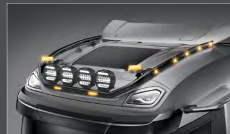
28705-5-B - 28705-11-B - LightFix - SKY-LIGHT "CLASSIC-MAX" DAF XG (28705-5-B) / DAF XF (28705-11-B) Extraljusbåge för montage av maximalt 4 extraljus och 2 varningsljus Rostfritt stål - svart pulverlackerad - Ø 70mm - monterad kabel inkl. 8 orange LED åt sidan samt röda LED i slutet av röret
