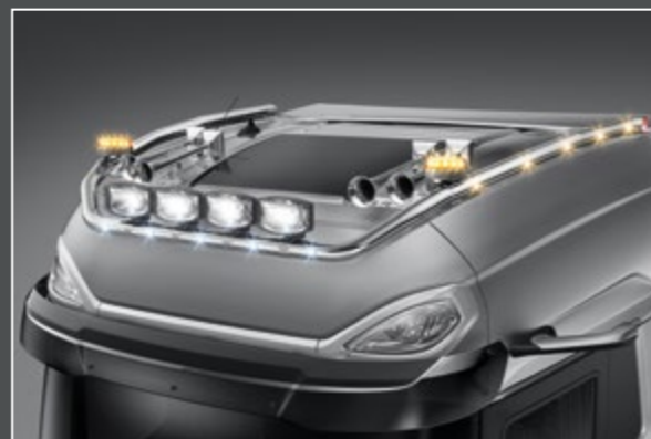
28706-5-P - LightFix - SKY-LIGHT "CLASSIC-MAX" Dachlampenbügel für maximal 4 Scheinwerfer und 2 Kennleuchten Edelstahl - hochglanzpoliert - Ø 70mm - mit Kabelsatz inkl. roten LEDs in den Rohrenden und 8 orangen LEDs an den Seiten
