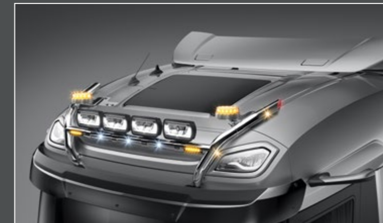
28705-8-P - LightFix - SKY-LIGHT "H-TYPE" Dachlampenbügel für maximal 4 Scheinwerfer und 2 Kennleuchten Edelstahl - hochglanzpoliert - Ø 70mm - mit Kabelsatz inkl. roten LEDs in den Rohrenden
