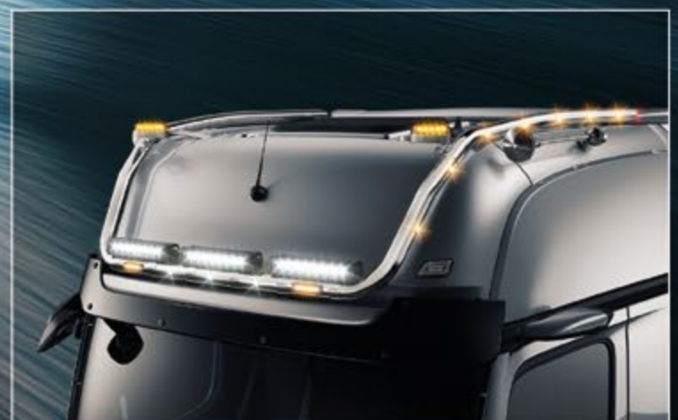
25707-7-P / -B - 25707-8-P / -B - LightFix - SKY-LIGHT "V-MAX" Big Space (25707-7-P / -B) / Giga Space (25707-8-P / -B) Rampe de toit pour la fixation au maximum de 6 phares et 2 gyrophares Inox - polissage haute brillance au noir thermolaqué - Ø 70mm - précâblage incl. LED rouges vers l'arrière et LED 8 oranges sur les côtés
