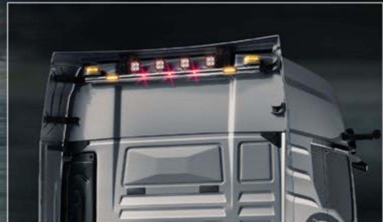
21715-2-P /-B - LightFix - REAR-LIGHT MAN TGX GX - MAN TGX GM - MAN TGS TM Dachlampenbügel für max. 4 Arbeitsscheinwerfer und 2 Kennleuchten Edelstahl - hochglanzpoliert oder schwarz pulverbeschichtet - Ø 70mm - mit Kabelsatz passend nur für Fahrzeuge mit Dachspoiler
