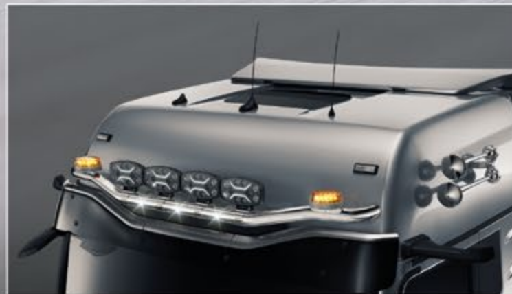
21706-2-P /-B - LightFix - SKY-LIGHT "WING" Dachlampenbügel für max. 4 Scheinwerfer und 2 Kennleuchten Edelstahl - hochglanzpoliert oder schwarz pulverbeschichtet - Ø 70mm - mit Kabelsatz
