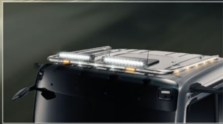
21704-3-P /-B - LightFix - SKY-LIGHT "MAXIMUM" Dachlampenbügel für max. 6 Scheinwerfer und 2 Kennleuchten Edelstahl - hochglanzpoliert oder schwarz pulverbeschichtet - Ø 70mm - mit Kabelsatz inkl. roten LEDs in den Rohrenden und orangen LEDs an den Seiten
