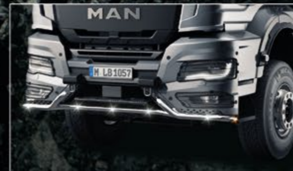
21741-3-P / -B - 21741-5-P / -B LightFix - FRONT-LINER "S" MAN TGX (21741-3-P / -B) / MAN TGS (21741-5-P / -B) nur für Baustellenfahrzeuge LED-Lampenbügel für die Front aus Edelstahl Edelstahl - hochglanzpoliert oder schwarz pulverbeschichtet Ø 70mm - mit Kabelsatz inkl. weißen LEDs nach vorne und orangen LEDs an den Seiten
