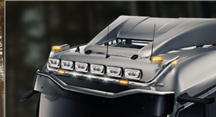
21702-9-P /-B - LightFix - SKY-LIGHT "WILDLIFE" Dachlampenbügel für max. 6 Scheinwerfer und 2 Kennleuchten Edelstahl - hochglanzpoliert oder schwarz pulverbeschichtet Ø 70mm - mit Kabelsatz inkl. roten LEDs in den Rohrenden
