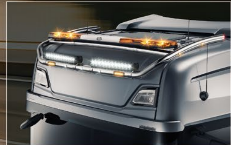
24705-12-P /-B - LightFix - SKY-LIGHT + SKY-BRIDGE Dachlampenbügel mit Querrohr für maximal 6 Scheinwerfer und einen Warnbalken Edelstahl - hochglanzpoliert oder schwarz pulverbeschichtet - Ø 70mm - mit Kabelsatz inkl. roten LEDs in den Rohrenden und orangen LEDs an den Seiten
