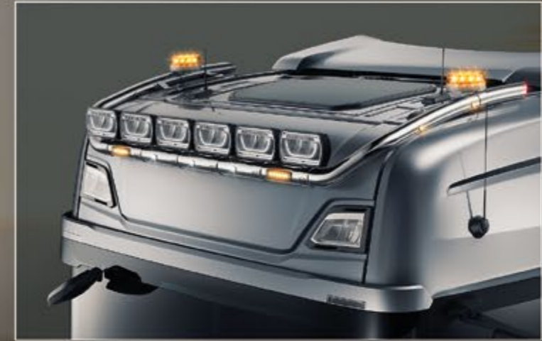
24705-10-P /-B - LightFix - SKY-LIGHT "MAXIMUM" Dachlampenbügel für maximal 6 Scheinwerfer und 2 Kennleuchten Edelstahl - hochglanzpoliert oder schwarz pulverbeschichtet - Ø 70mm - mit Kabelsatz inkl. roten LEDs in den Rohrenden und orangen LEDs an den Seiten
