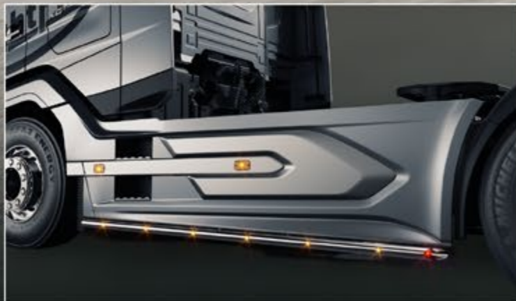
28742-X-P /-B - LightFix - SIDE-LINER (ohne oder mit Nebenantrieb) WB 3800mm: 28742-2-P /-B (ohne) oder 28742-5-P /-B (mit Nebenantrieb) WB 3600mm: 28742-3-P /-B (ohne) oder 28742-6-P /-B (mit Nebenantrieb) LED-Seitenschutzbügel für Fahrer- und Beifahrerseite aus Edelstahl hochglanzpoliert oder schwarz pulverbeschichtet - Ø 60mm - Kabelsatz inkl. roten LEDs in den Rohrenden und orangen LEDs an den Seiten
