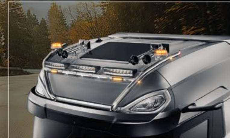
28706-8-P /-B - LightFix - SKY-LIGHT "H-TYPE" Dachlampenbügel für maximal 6 Scheinwerfer und 2 Kennleuchten Edelstahl - hochglanzpoliert oder schwarz pulverbeschichtet - Ø 70mm - mit Kabelsatz inkl. roten LEDs in den Rohrenden
