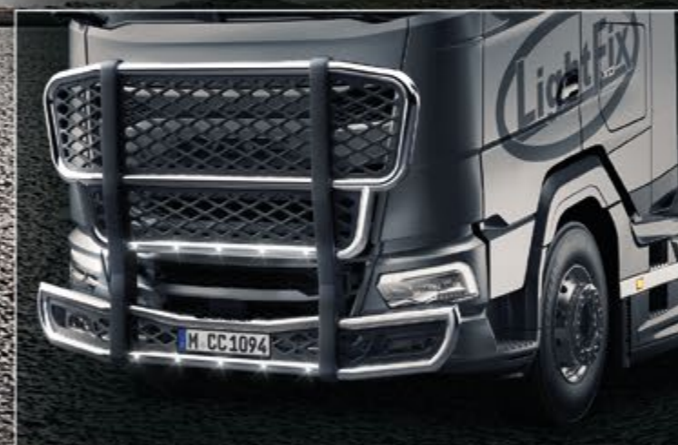
28760-3-P /-B - LightFix - FRONT-PROTECT "BIG NORDIC" Frontschutzgrill aus Edelstahl hochglanzpoliert oder schwarz pulverbeschichtet - Ø 70mm - mit Kabelsatz inkl. schwarzem Schutznetz aus ABS (lackierbar)
