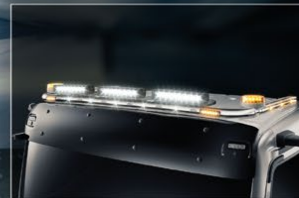
21704-3-P /-B - 21704-4-P /-B - LightFix - SKY-LIGHT "MAXIMUM" MAN TGS TN (21704-3-P /-B) / MAN TGS NN (21704-4-P /-B) Barra portafari per il montaggio fino a 4 fari ausiliari e 2 rotanti acciaio inossidabile lucidato a mano o verniciato nero Ø 70mm - al 100% predisposto - con cablaggio nelle prolunghe sono già incluso LED arancioni e in rosso
