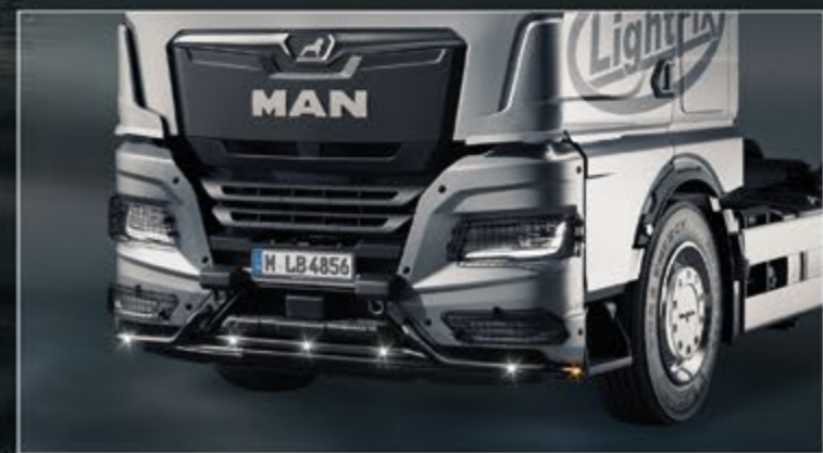
21741-3-P /-B - LightFix - FRONT-LINER "S" MAN TGS -Construction- Tubo inferiore in acciaio inossidabile lucidato a mano o verniciato nero - Ø 60mm - al 100% predisposto con cablaggio completo di LED bianchi e LED arancioni
