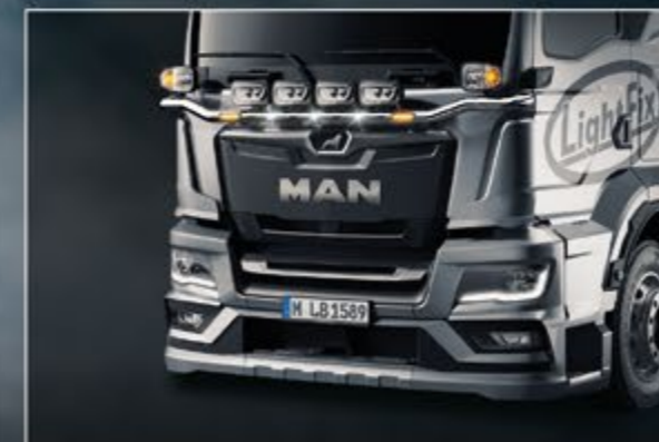
21750-4-P /-B - LightFix - PLOW-LIGHT Barra portafari frontale per fino a 4 fari ausiliari e 2 fari principali adatto per veicoli spazzaneve e veicoli comunali acciaio inossidabile lucidato a mano o verniciato nero - Ø 70mm al 100% predisposto - con cablaggio
