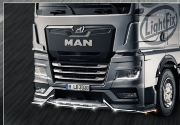
21741-1-P /-B - LightFix - FRONT-LINER "S" Tubo inferiore in acciaio inossidabile lucidato a mano o verniciato nero Ø 60mm - al 100% predisposto - con cablaggio completo di LED bianchi e LED arancioni
