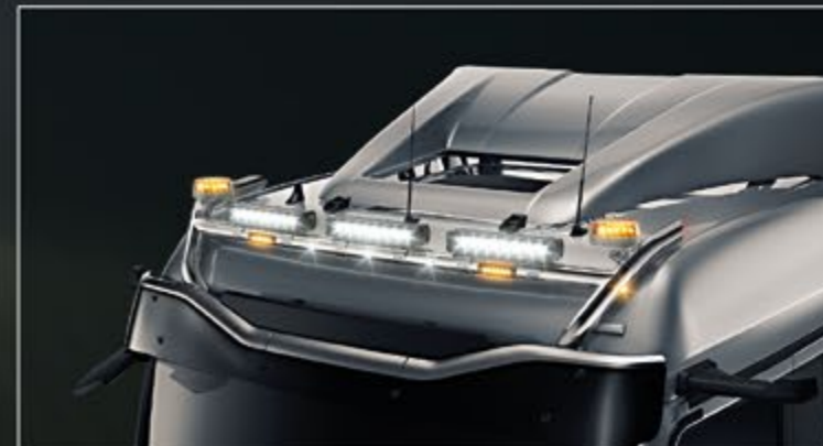
21702-5-P /-B - LightFix - SKY-LIGHT "H-TYPE" Barra portafari per il montaggio fino a 6 fari ausiliari e 2 rotanti acciaio inossidabile lucidato a mano o verniciato nero Ø 70mm - al 100% predisposto - con cablaggio incl. alla fine del tubo si trovano LED in rosso
