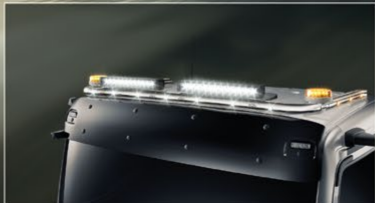
21704-3-P /-B - 21704-4-P /-B - LightFix - SKY-LIGHT "MAXIMUM" Barra portafari per il montaggio fino a 4 fari ausiliari e 2 rotanti acciaio inossidabile lucidato a mano o verniciato nero Ø 70mm - al 100% predisposto - con cablaggio nelle prolunghe sono già incluso 6 LED arancioni e 2 in rosso
