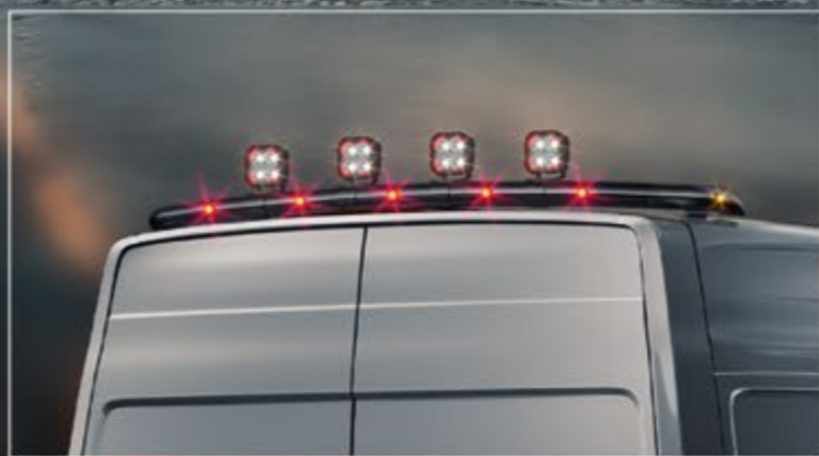
21790-6-P /-B - LightFix - REAR-LIGHT MAN TGE - H2 Barra portafari per il montaggio fino a 4 fari da lavoro e 2 rotanti acciaio inossidabile lucidato a mano o verniciato nero Ø 70mm - al 100% predisposto - con cablaggio
