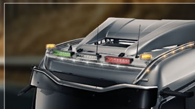
21702-7-P /-B - LightFix - SKY-LIGHT "H-MAX" Barra portafari per il montaggio fino a 6 fari ausiliari e 2 rotanti acciaio inossidabile lucidato a mano o verniciato nero Ø 70mm - al 100% predisposto con cablaggio nelle prolunghe sono già incluso 8 LED arancioni e 2 in rosso
