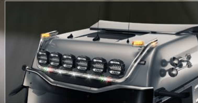
21706-4-P /-B - LightFix - SKY-LIGHT "WILDLIFE" Barra portafari per il montaggio fino a 6 fari ausiliari e 2 rotanti acciaio inossidabile lucidato a mano o verniciato nero Ø 70mm - al 100% predisposto - con cablaggio incl. alla fine del tubo si trovano LED in rosso
