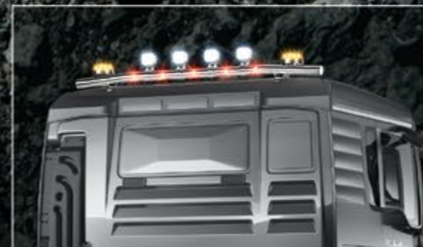
21715-1-P /-B - LightFix - REAR-LIGHT Barra portafari per il montaggio fino a 4 fari da lavoro e 2 rotanti acciaio inossidabile lucidato a mano o verniciato nero Ø 70mm - al 100% predisposto - con cablaggio
