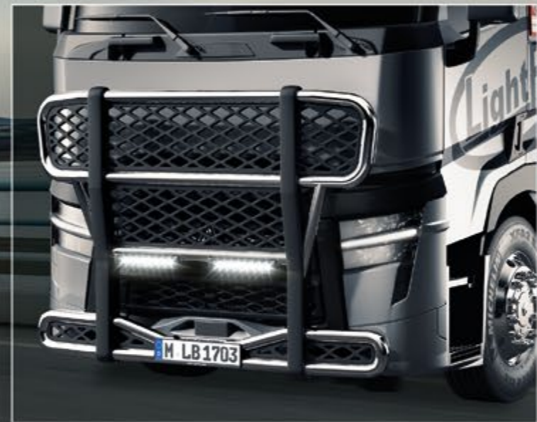
TLG20760-2-P /-B - LightFix - FRONT-PROTECT "BIG NORDIC" Renault T - Renault C 2500 Griglia frontale con una rete in nero - acciaio inossidabile lucidato a mano o verniciato nero - Ø 70mm - al 100% predisposto - con cablaggio TLG29708-1-P /-B - LightFix - LAZER-BRIDGE per LAZER Triple-R 1000
