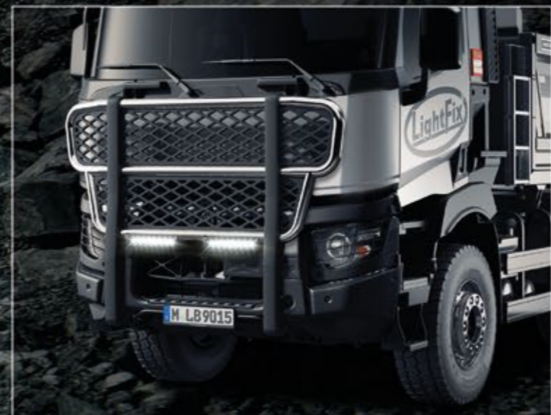
TLG20761-1-P - LightFix - FRONT-PROTECT "NORDIC" Griglia frontale con una rete in nero - Acciaio inossidabile acciaio inossidabile lucidato a mano - Ø 70mm - al 100% predisposto con cablaggio TLG29708-1-P - LightFix - LAZER-BRIDGE per LAZER Triple-R 1000
