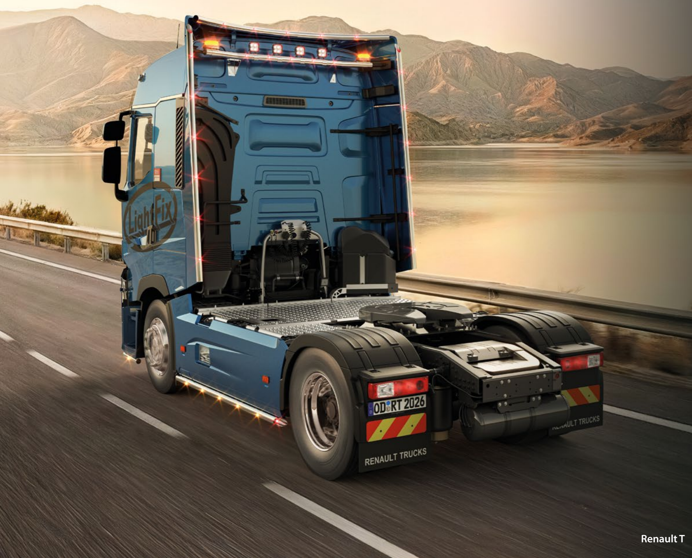
TLG20748-6-P /-B - LightFix - ROOF-LINER Barra portafari per fino a 4 fari da lavoro e 2 rotanti per il spoiler della cabina Acciaio inossidabile lucidato a mano o verniciato nero - Ø 70mm al 100% predisposto con cablaggio completo di LED rossi
