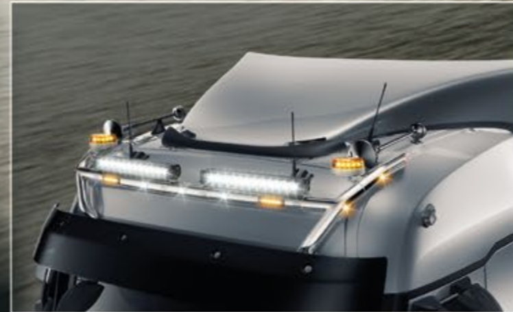
TLG20701-4-P / -B - LightFix - SKY-LIGHT "WILDLIFE" Barra portafari per il montaggio fino a 6 fari ausiliari e 2 rotanti Acciaio inossidabile lucidato a mano o verniciato nero - Ø 70mm al 100% predisposto con cablaggio incl. alla fine del tubo si trovano LED in rosso
