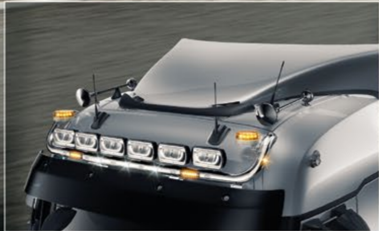
TLG20701-3-P / -B - LightFix - SKY-LIGHT Barra portafari per il montaggio fino a 6 fari ausiliari e 2 rotanti Acciaio inossidabile lucidato a mano o verniciato nero - Ø 70mm al 100% predisposto con cablaggio
