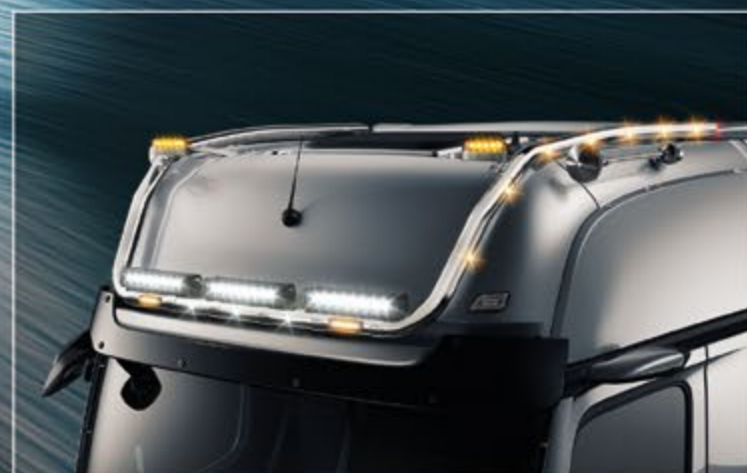
25707-7-P /-B - 25707-8-P /-B - LightFix - SKY-LIGHT "V-MAX" Big Space (25707-7-P /-B) / Giga Space (25707-8-P /-B) Lygtebøjle til montering af maksimalt 6 ekstra lygter og advarselslygter. Rustfrit stål - Poleret eller sort pulverlakeret - Ø 70 mm - Færdigtrukket kabel. Rød LED i enden af røret samt 8 gule LED'er på siderne.
