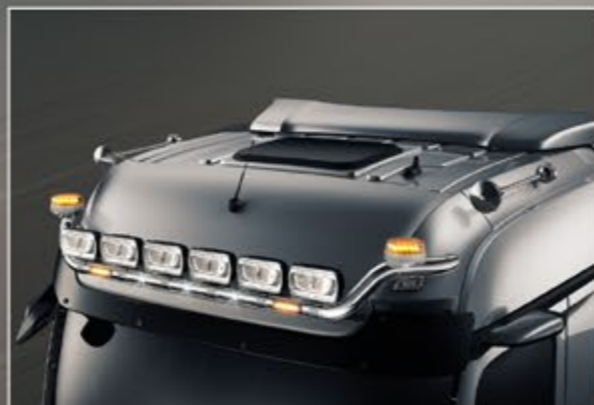
25706-2-P /-B - LightFix - SKY-LIGHT "WING" Big Space / Giga Space Lygtebøjle til montering af maks. 6 ekstra lygter og advarselslygter. Rustfrit stål - Poleret eller sort pulverlakeret - Ø 70 mm. Færdigtrukket kabel.
