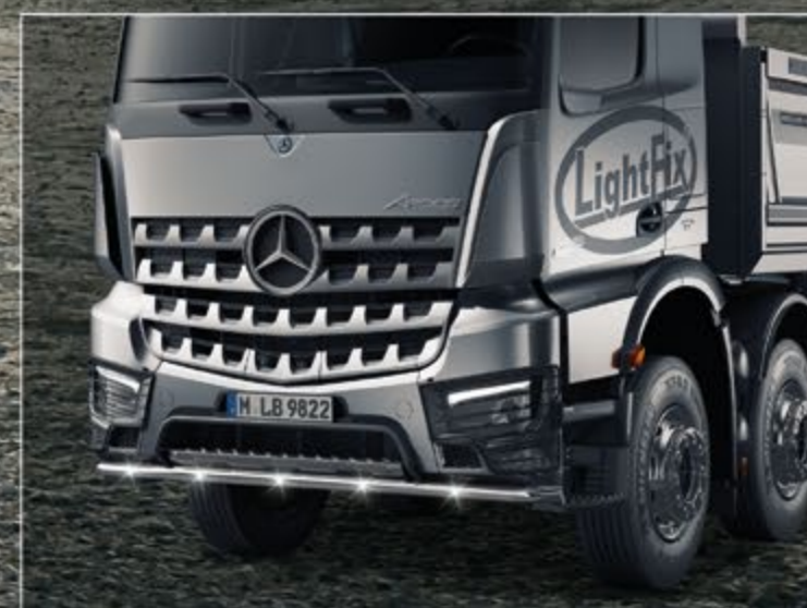
25740-1-P /-B - LightFix - FRONT-LINER "N" Arocs 2300mm LED lygtebøjle til fronten i rustfrit stål. Poleret eller sort pulverlakeret - Ø 60 mm - Færdigtrukket kabel. Hvide LED'er foran.
