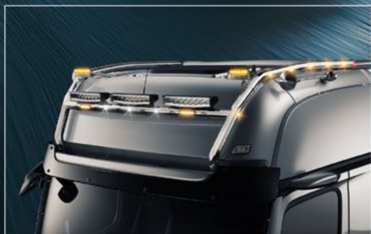
25707-5-P /-B - 25707-6-P /-B - LightFix - SKY-LIGHT "H-MAX" Big Space (25707-5-P /-B) / Giga Space (25707-6-P /-B) Lygtebøjle til montering af maksimalt 6 ekstra lygter og advarselslygter. Rustfrit stål - Poleret eller sort pulverlakeret - Ø 70 mm - Færdigtrukket kabel. Rød LED i enden af røret samt 8 gule LED'er på siderne.
