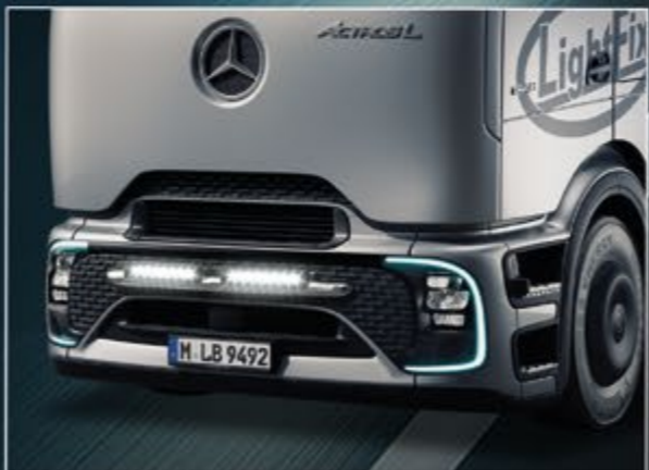
25722-2-P /-B - LightFix - 2-LIGHT "LAZER" Lygtebøjle i rustfrit stål til montering af 2 LED lygter foran køretøjet. Poleret eller sort pulverlakeret - Ø 70 mm - Færdigtrukket kabel.
