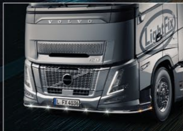
TLG23742-2-P /-B - LightFix - FRONT-LINER "N" z dolnego spojlera Orurowanie lamp LED ze stali nierdzewnej polerowana lub czarny - Ø 60mm - z okablowaniem w zestawie 5 białe diody LED z przodu i 4 pomarańczowe LED po bokach
