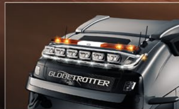
TLG23704-6-P /-B - LightFix - SKY-LIGHT + SKY-BRIDGE Globetrotter / Globetrotter XL / Globetrotter XXL Rama dachowa do maksymalnie 6 reflektorów lub belka sygnalizacyjna Stal nierdzewna - polerowana lub czarny - Ø 70mm z okablowaniem
