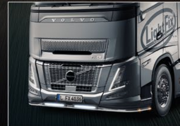
TLG23742-4-P /-B - LightFix - FRONT-LINER "LAZER" mit unterer Spoilerlippe Lampenbügel für die Front aus Edelstahl für 2 LED Scheinwerfer hochglanzpoliert oder schwarz pulverbeschichtet - Ø 60mm mit Kabelsatz inkl. 4 orangen LEDs an den Seiten
