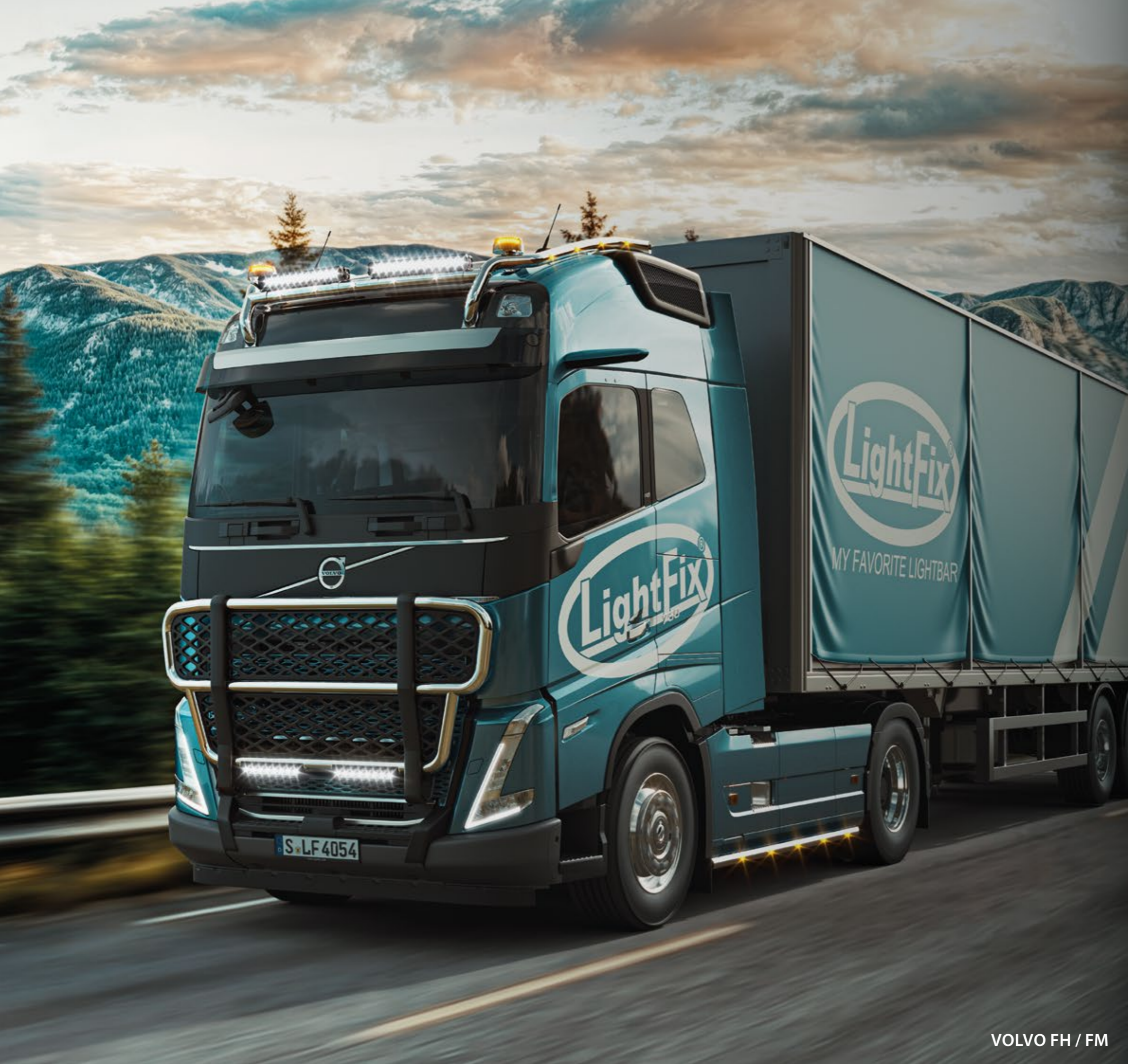
TLG23760-2-P /-B - LightFix - FRONT-PROTECT "BIG NORDIC" - FH Frontschutzgrill aus Edelstahl inkl. schwarzem Schutznetz aus ABS hochglanzpoliert oder schwarz pulverbeschichtet - Ø 70mm - Kabelsatz TLG29708-1-P /-B - LightFix - LAZER-BRIDGE für Lazer Triple-R 1000
