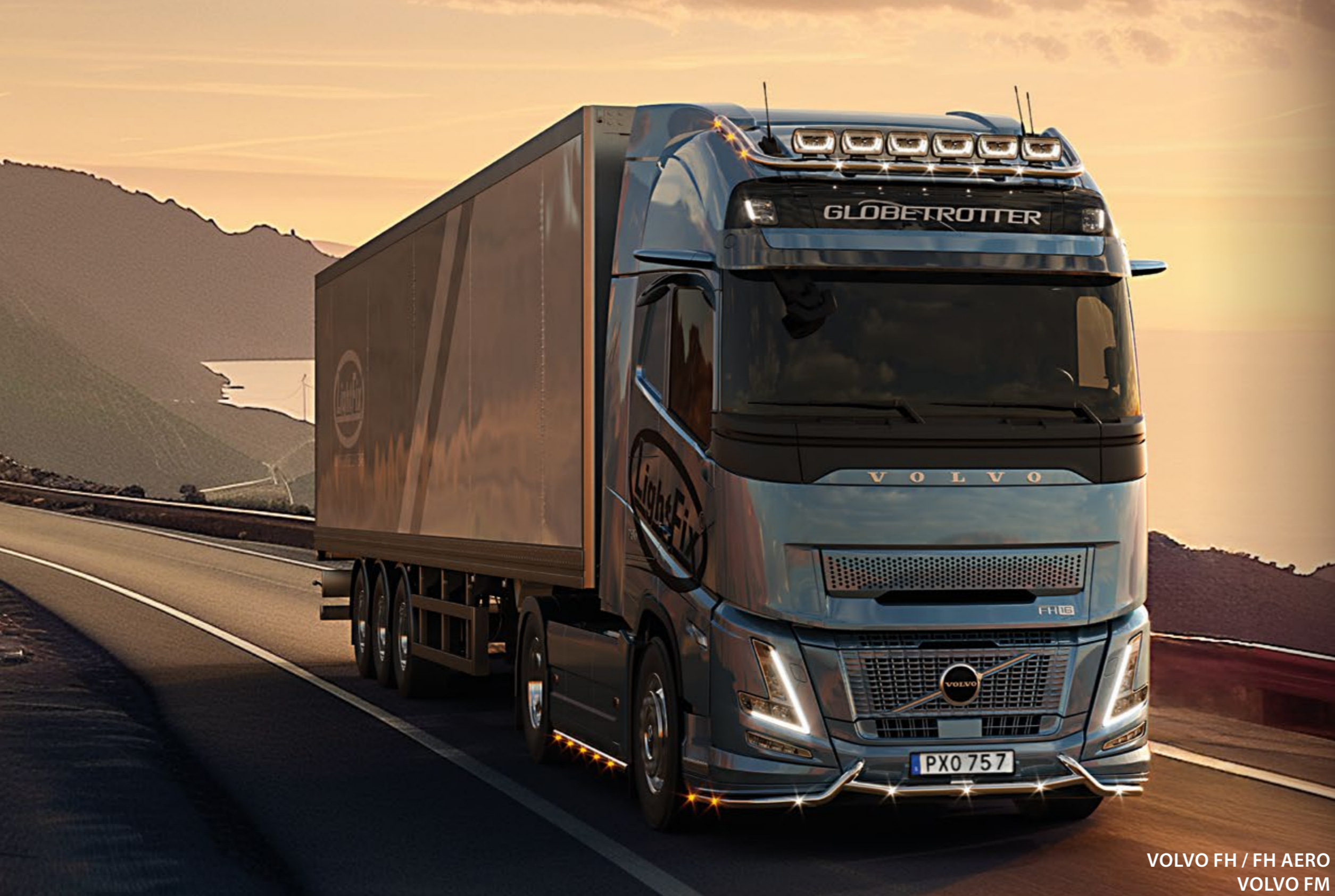
TLG23704-10-P /-B - LightFix - SKY-LIGHT "BIG" Globetrotter / Globetrotter XL / Globetrotter XXL Dachlampenbügel für max. 6 Scheinwerfer und 2 Kennleuchten Edelstahl - hochglanzpoliert oder schwarz pulverbeschichtet Ø 70mm - mit Kabelsatz inkl. orangen LEDs an den Seiten
