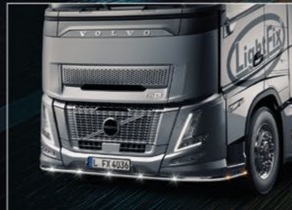
TLG23742-2-P /-B - LightFix - FRONT-LINER "N" ohne untere Spoilerlippe Lampenbügel für die Front aus Edelstahl hochglanzpoliert oder schwarz pulverbeschichtet - Ø 60mm mit Kabelsatz inkl. 5 weißen LEDs nach vorne und 4 orangen LEDs an den Seiten
