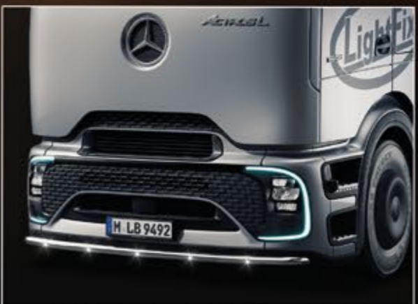
25741-3-P /-B - LightFix - FRONT-LINER mit aerodynamischer Bodenverkleidung (CSJ + CSK) LED-Lampenbügel für die Front aus Edelstahl hochglanzpoliert oder schwarz pulverbeschichtet Ø 60mm - Kabelsatz inkl. weißen LEDs nach vorne
