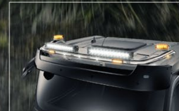
25704-4-P /-B - LightFix - SKY-LIGHT Classic Space Low (F2Y) Dachlampenbügel für maximal 6 Scheinwerfer und 2 Kennleuchten Edelstahl - hochglanzpoliert oder schwarz pulverbeschichtet Ø 70mm - Kabelsatz
