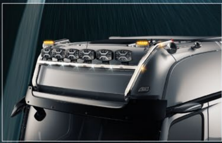
25707-1-P /-B - 25707-2-P /-B - LightFix - SKY-LIGHT "H-TYPE" Big Space (25707-1-P /-B) / Giga Space (25707-2-P /-B) Dachlampenbügel für maximal 6 Scheinwerfer und Kennleuchten Edelstahl - hochglanzpoliert oder schwarz pulverbeschichtet - Ø 70mm - Kabelsatz inkl. roten LEDs in den Rohrenden
