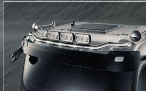
25704-2-P /-B - LightFix - SKY-LIGHT "WING" Dachlampenbügel für maximal 4 Scheinwerfer und 2 Kennleuchten Edelstahl - hochglanzpoliert oder schwarz pulverbeschichtet Ø 70mm - Kabelsatz
