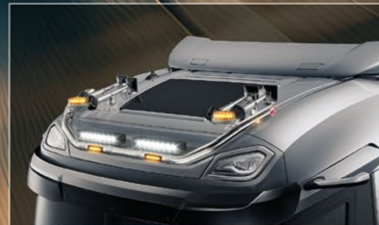
28705-4-P /-B - LightFix - SKY-LIGHT "CLASSIC" Lygtebøjle til maksimalt 4 ekstra lygter og advarselslygter. Rustfrit stål - Poleret eller sort pulverlakeret - Ø 70mm - Færdigtrukket kabel. Rød LED i enden af røret.
