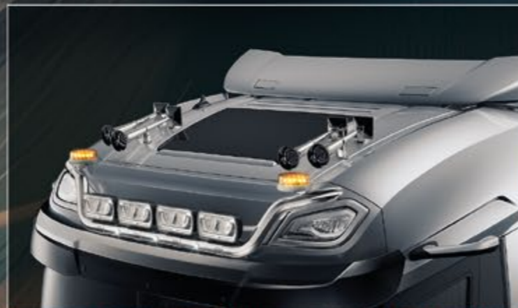
28705-3-P /-B - LightFix - SKY-LIGHT "WING" Lygtebøjle til maksimalt 4 ekstra lygter og advarselslygter. Rustfrit stål - Poleret eller sort pulverlakeret - Ø 70mm - Færdigtrukket kabel.
