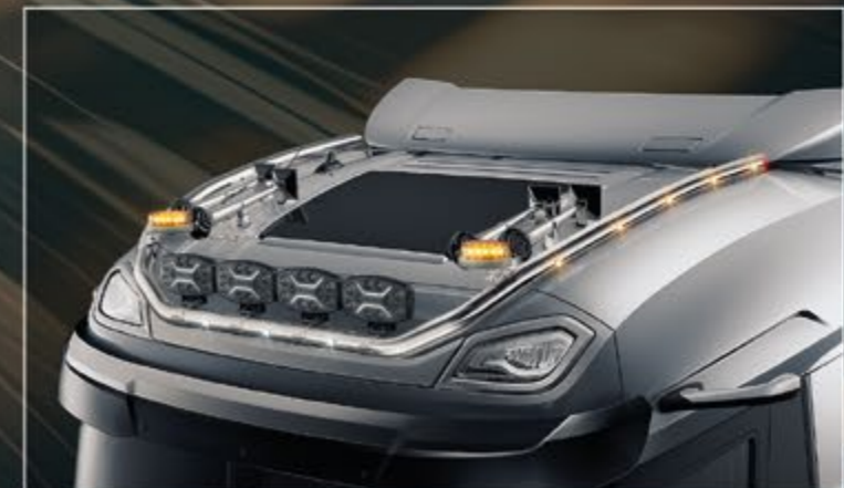
28705-5-P /-B - 28705-11-P /-B - LightFix - SKY-LIGHT "CLASSIC-MAX" DAF XG (28705-5-P /-B) / DAF XF (28705-11-P /-B) Lygtebøjle til maksimalt 4 ekstra lygter og advarselslygter. Rustfrit stål - Poleret eller sort pulverlakeret - Ø 70mm - Færdigtrukket kabel. Rød LED i enden af røret samt 8 gule LED'er på siderne.
