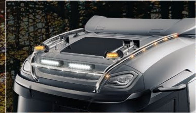
28705-9-P /-B - 28705-12-P /-B - LightFix - SKY-LIGHT "H-MAX" DAF XG (28705-9-P /-B) / DAF XF (28705-12-P /-B) Lygtebøjle til maksimalt 4 ekstra lygter og advarselslygter. Rustfrit stål - Poleret eller sort pulverlakeret - Ø 70mm - Færdigtrukket kabel. Rød LED i enden af røret samt 8 gule LED'er på siderne.
