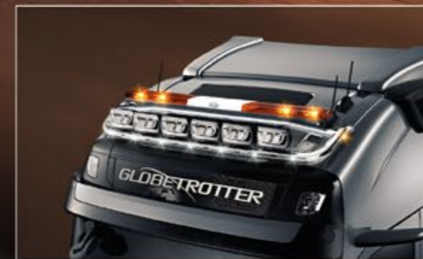
TLG23704-6-P /-B - LightFix - SKY-LIGHT + SKY-BRIDGE Globetrotter / Globetrotter XL / Globetrotter XXL Dachlampenbügel mit Querrohr für max. 6 Scheinwerfer und einen Warnbalken Edelstahl - hochglanzpoliert oder schwarz pulverbeschichtet Ø 70mm - mit Kabelsatz
