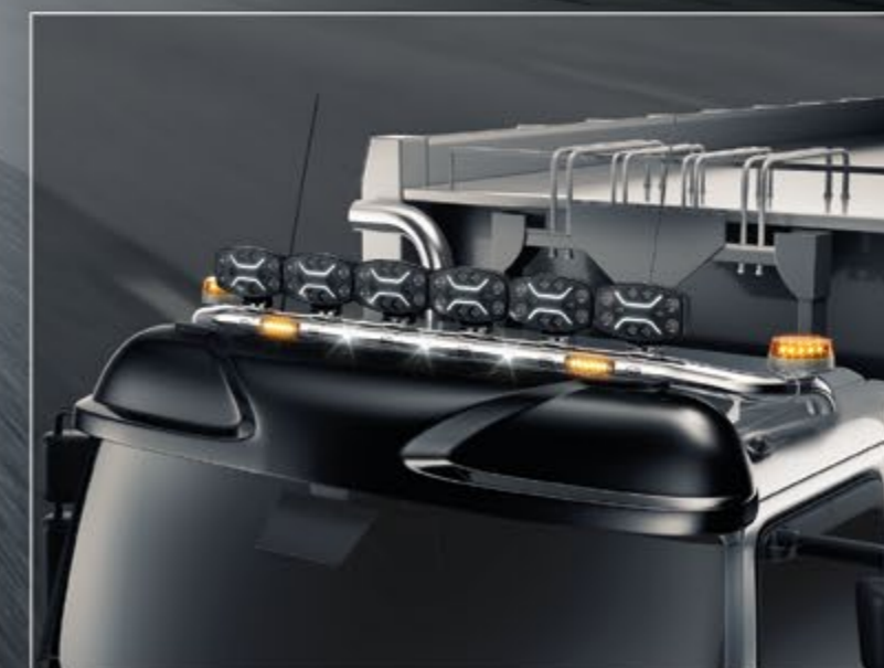
TLG20706-2-P - LightFix - SKY-LIGHT Renault D 2100 Dachlampenbügel für maximal 6 Scheinwerfer und 2 Kennleuchten Edelstahl - hochglanzpoliert - Ø 70mm - mit Kabelsatz
