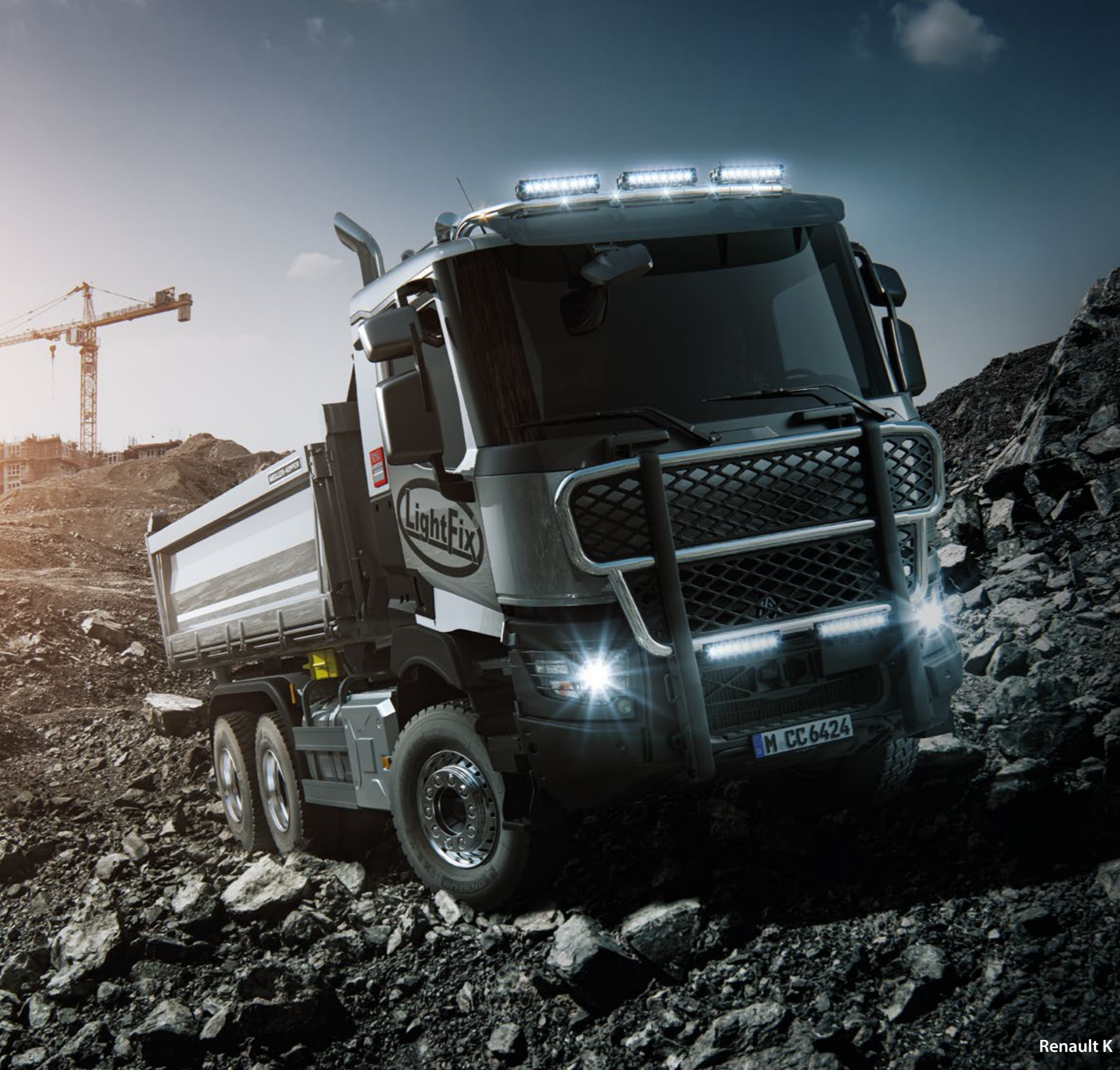
TLG20702-1-P /-B - LightFix - SKY-LIGHT Dachlampenbügel für max. 6 Scheinwerfer und 2 Kennleuchten Edelstahl - hochglanzpoliert oder schwarz pulverbeschichtet Ø 70mm - mit Kabelsatz
