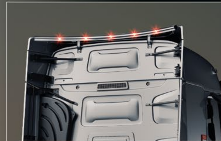
TLG20748-6-P /-B - LightFix - ROOF-LINER LED-Dachlampenbügel aus Edelstahl zur Montage am Dachspoiler für max. 4 Arbeitsscheinwerfer und 2 Kennleuchten hochglanzpoliert oder schwarz pulverbeschichtet - Ø 70mm - mit Kabelsatz inkl. integrierten roten LEDs
