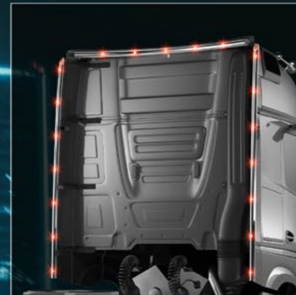
25749-1-P /-B - 25749-2-P /-B LightFix - ROOF-LINER Actros (ProCabin) Giga Space (25749-1-P /-B) Actros (ProCabin) Big Space / Giga Space "Lowliner" (25749-2-P /-B) LED-Lysbøyle i rustfritt stål for maks. 4 arbeidslys og 2 rotorblinklys på spoileret polert eller sort pulverlakkert - Ø 70mm - montert kabel inkl. integrerte rød LED
