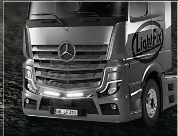
25722-1-P /-B - LightFix - 2-LIGHT "LAZER" Ekstralysbøyle for montering av 2 integrert LED lamper Rustfritt stål - polert eller sort pulverlakkert - Ø 70mm - montert kabel
