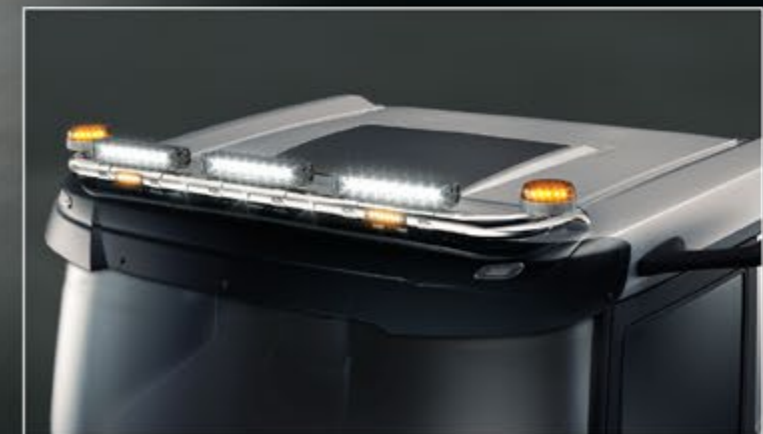
28704-3-P /-B - LightFix - SKY-LIGHT Rama dachowa na maksymalnie 6 reflektory i lampy sygnalizacyjne Stal nierdzewna - polerowana lub czarny - Ø 70mm - z okablowaniem
