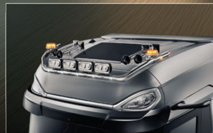
28706-4-P /-B - LightFix - SKY-LIGHT "CLASSIC" Rama dachowa na maksymalnie 4 reflektory i lampy sygnalizacyjne Stal nierdzewna - polerowana lub czarny - Ø 70mm - z okablowaniem czerwone LED na końcówkach rury
