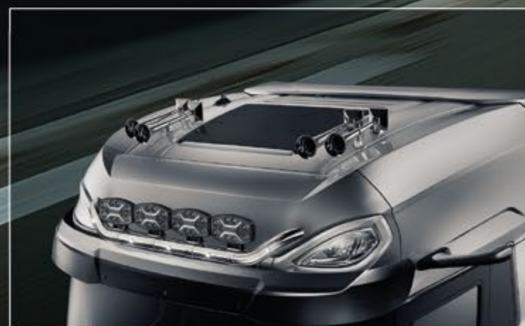
28706-3-P /-B - LightFix - SKY-LIGHT "WING" Rama dachowa na maksymalnie 4 reflektory Stal nierdzewna - polerowana lub czarny - Ø 70mm - z okablowaniem
